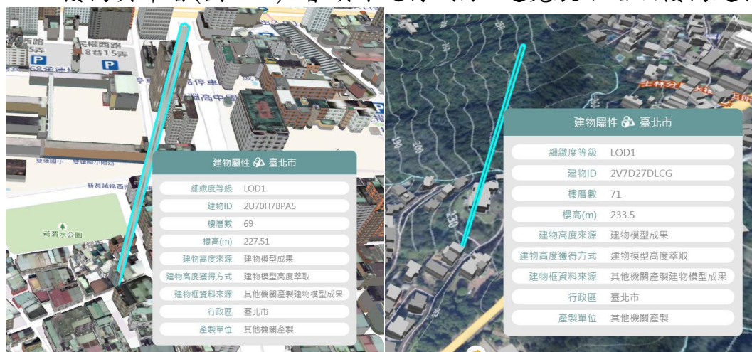
圖 5- 6 樓高異常移除作業
