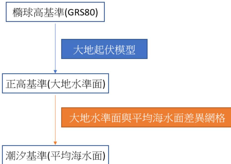
圖 10-1 高程基準轉換流程圖
