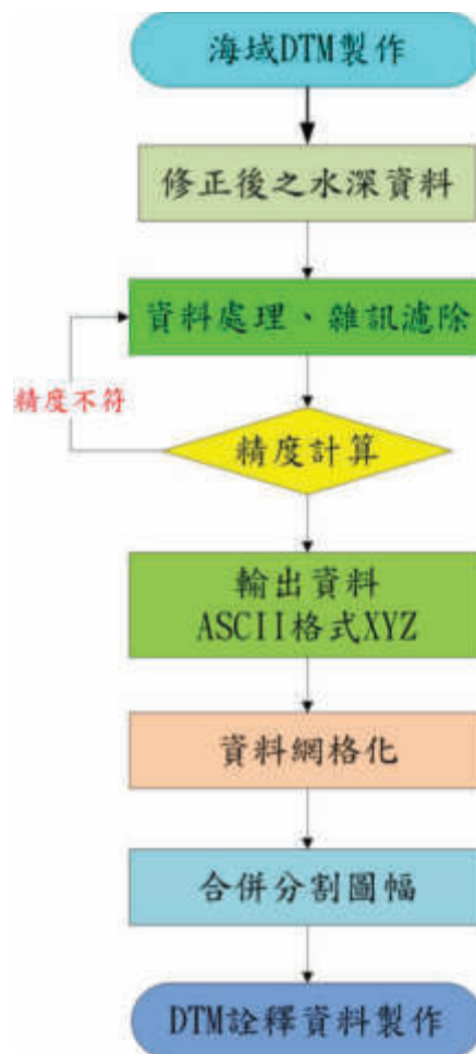
圖 3-42 海域數值地形模型 DTM 製作流程圖
