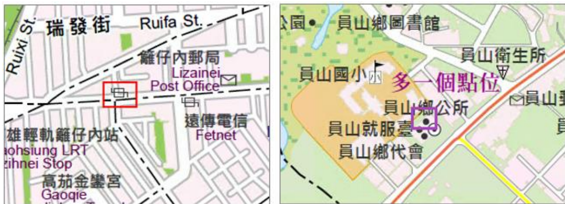
圖 4-6 圖面檢核：地標圖徵應與註記相符
