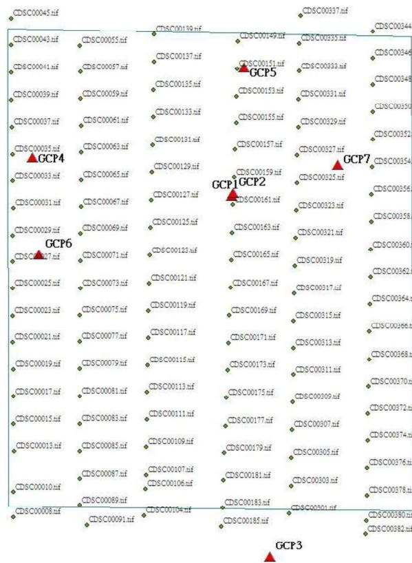
圖 3-119 臺北市士林區（大油坑）控制點(紅)/檢核點(綠)分布圖
