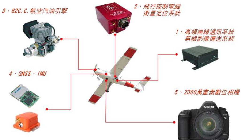
圖 2-3 國土測繪一號 UAS 系統架構
