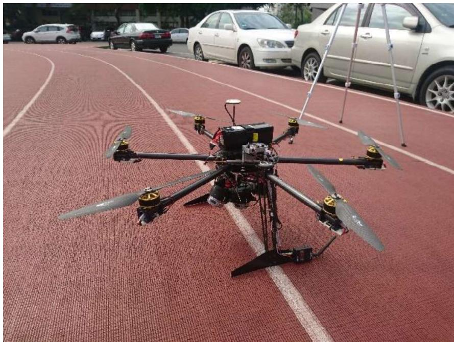
圖 4-1 旋翼型 UAS
