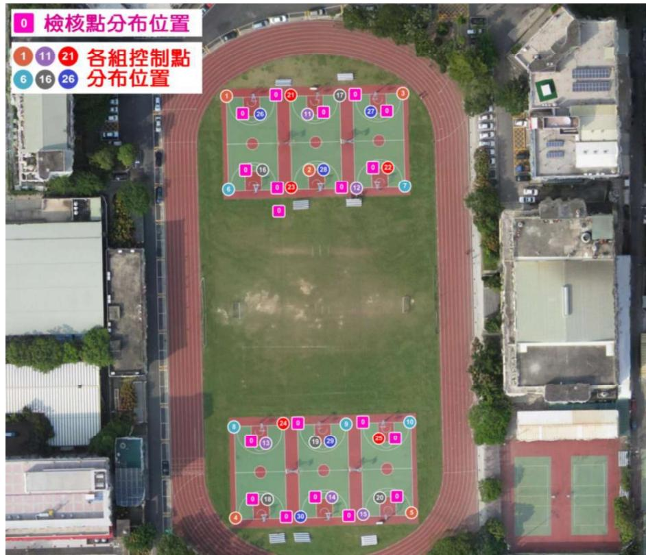
圖 4-7 Sony QX1 相機實驗組中檢核點及控制點分布圖
