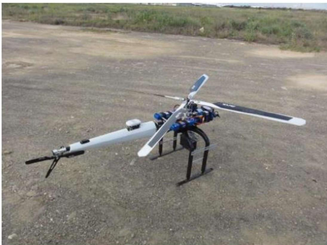
圖 5-4 單旋翼型 UAS
