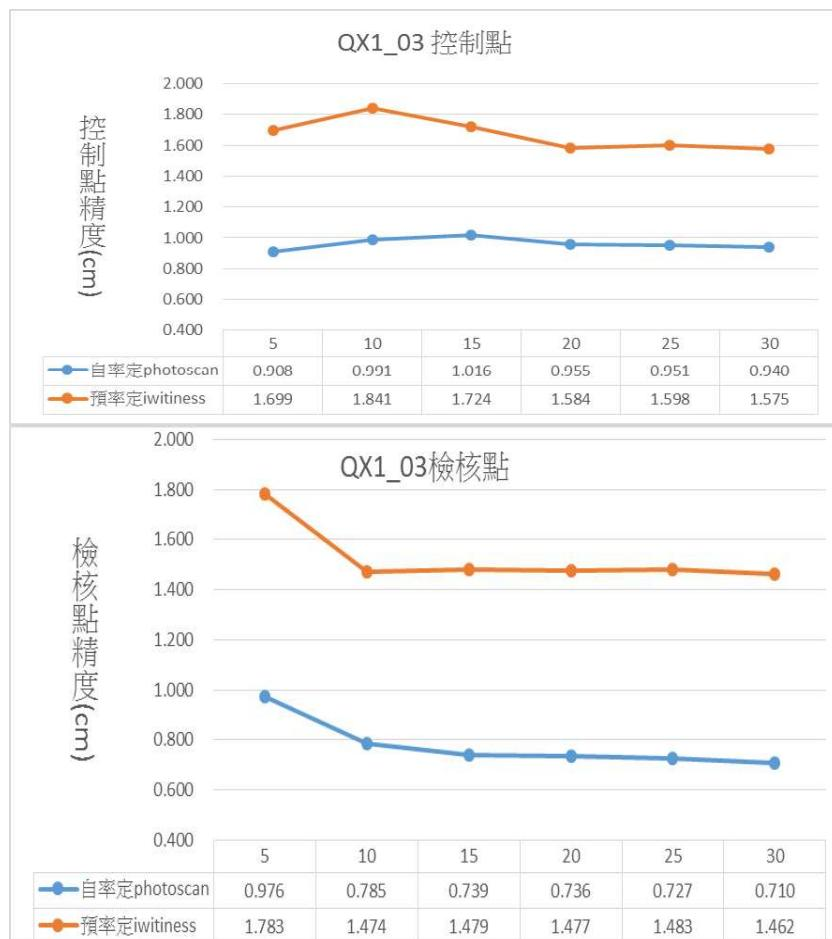
圖 4-13 Sony QX\_03 控制點及檢核點精度比較圖
