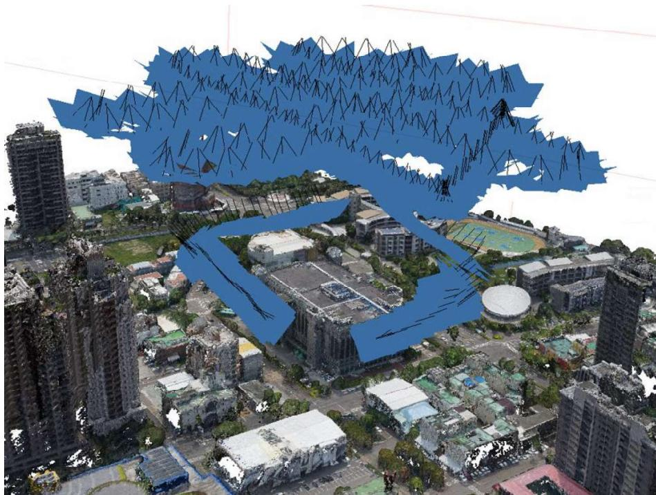
圖 4-29 UAS 結合低空環繞式拍攝軌跡
