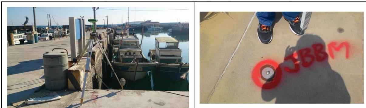
圖4-41 水深測量GPS固定站架設照片
