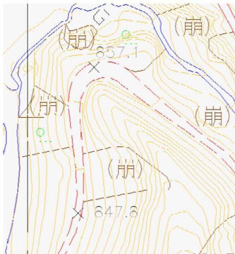
圖 6-1 崩塌區及道路虛線示意圖
