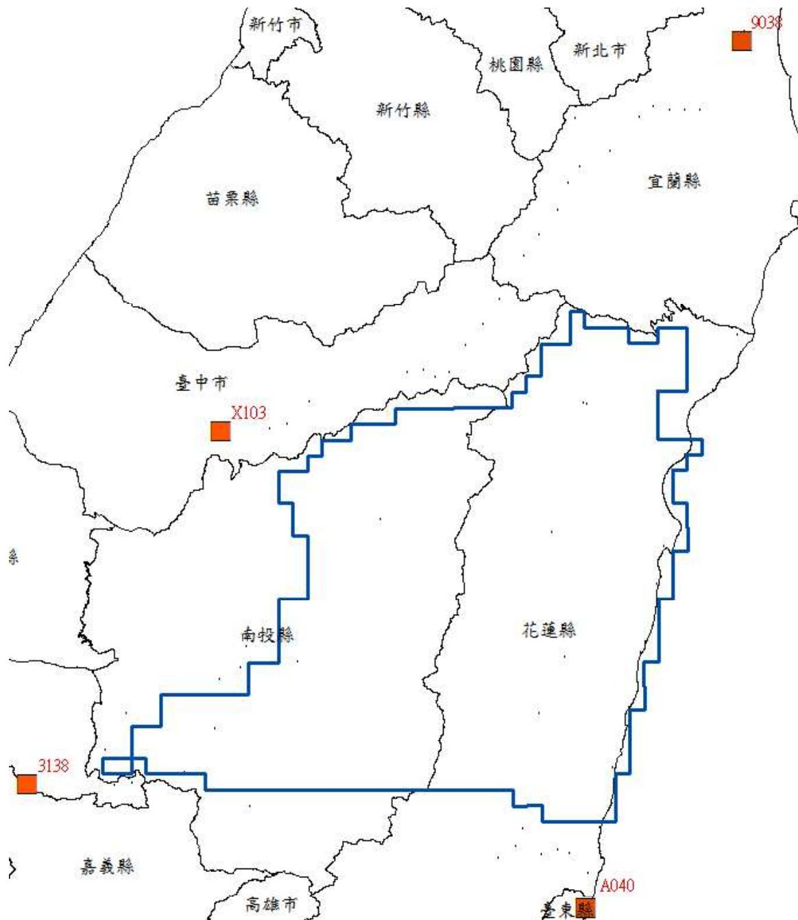
圖 7.2-4 檢測之已知水準點分布圖
