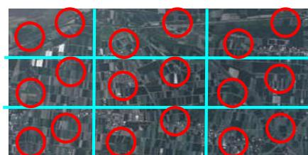
圖 5.2-1 空中三角量測點位示意圖
