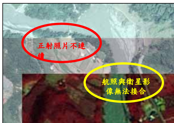
圖 3.2.1、正射照片與衛星影像彼此不吻合處
