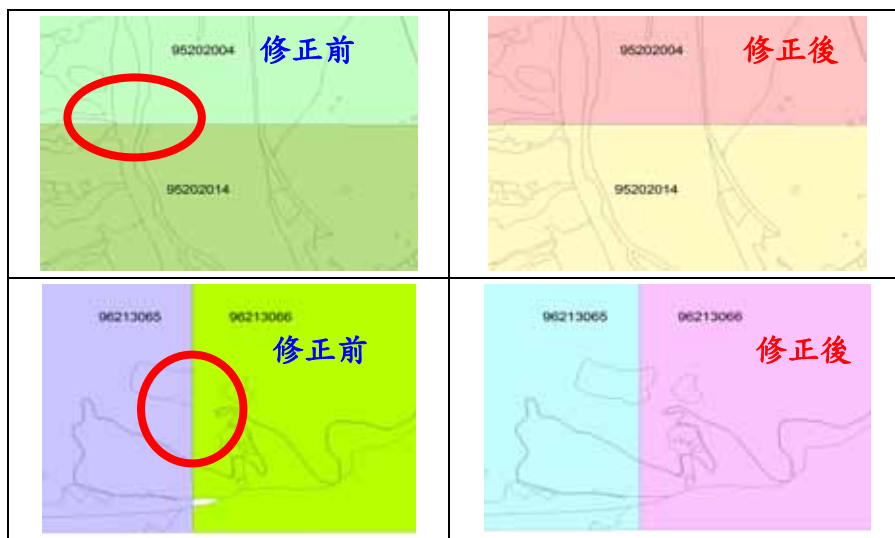
圖 3.2.4、內部審查相鄰圖幅無法接合與改正情形
