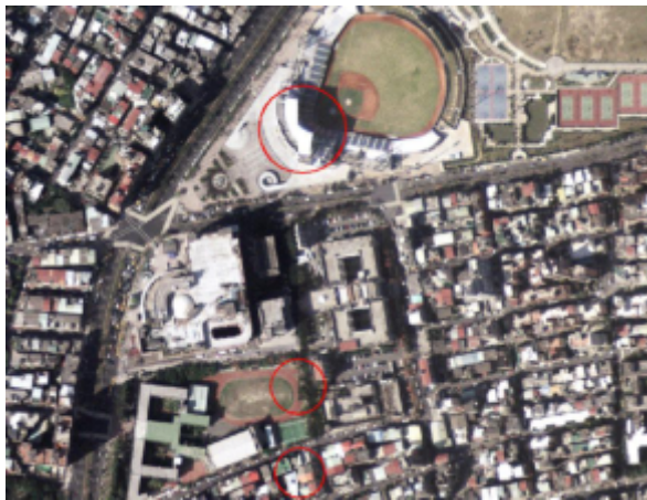
圖 5-77 影像接邊處明顯產生接邊不符情形
