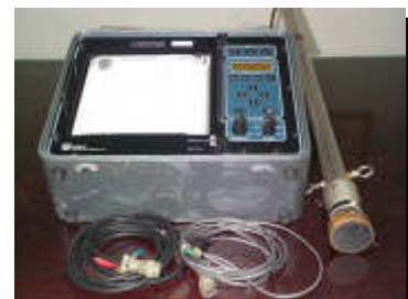
圖 4-14 Odom 單音束測深儀
