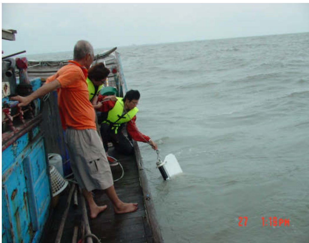
圖 5-42 王功漁港附近海域海上平面流況觀測作業-定點流速儀回收
