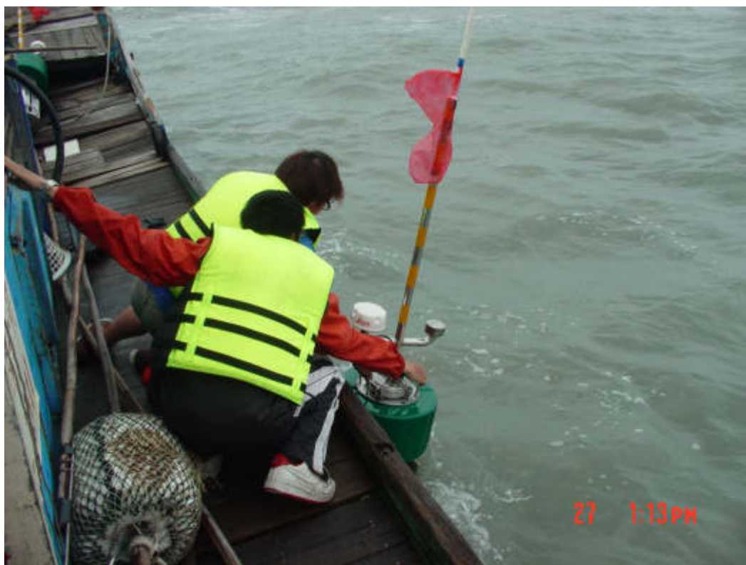
圖 5-41 王功漁港附近海域海上平面流況觀測作業-漂浮球回收
