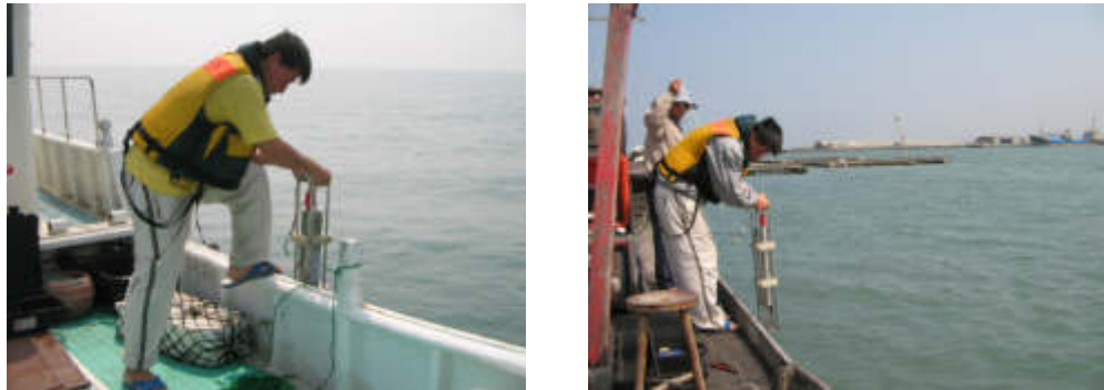
圖 5-24 聲速剖面儀測量情形
