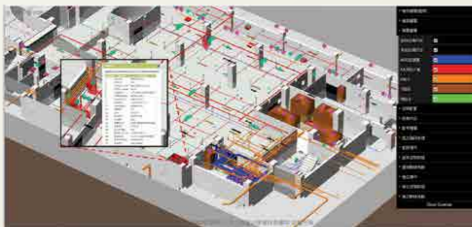
◀ BIM 建築空間資訊與設備 維護資訊整合查詢介面 資料來源：中華民國公共 工程資訊學會建築物維護 資料共同資訊圖台
