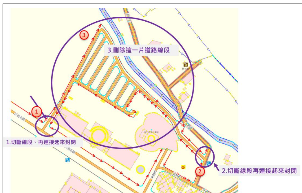
圖 6-12 道路面(邊界線)滅失區域編輯作法
