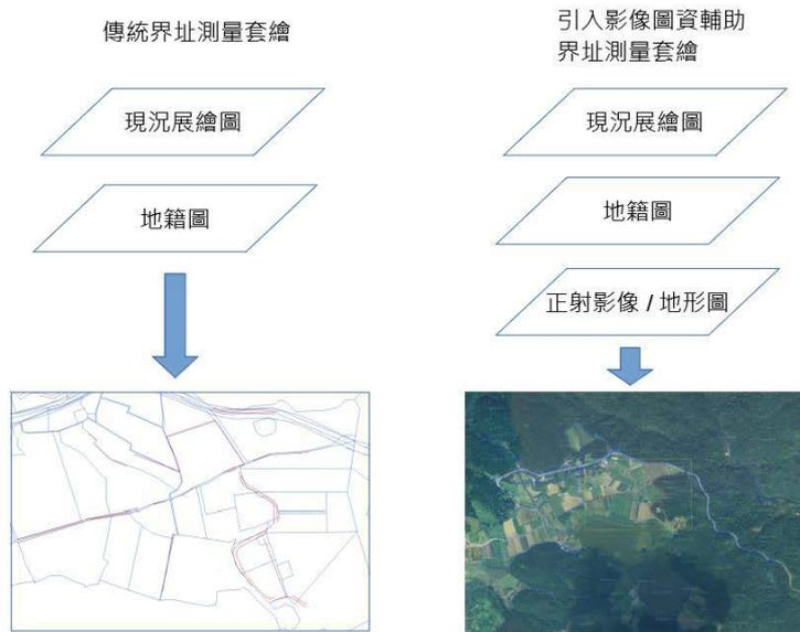
圖 1-3 傳統界址測量與引入影像圖資輔助套繪之比較
