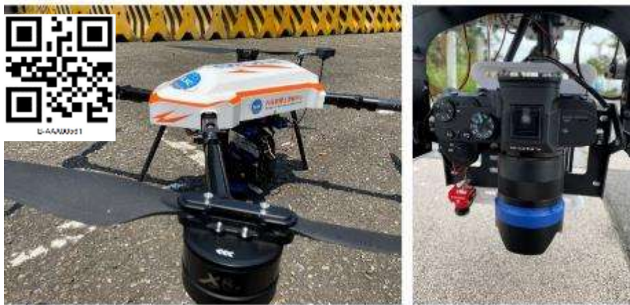
圖3-9 多旋翼機（含註冊碼）及酬載數位相機外觀
