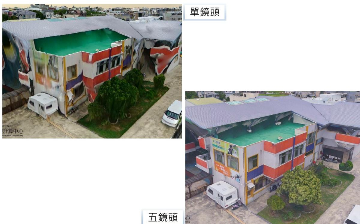
圖 4-64 傾斜與非傾斜攝影建模比較（國家高速網路與計算中心提供）
