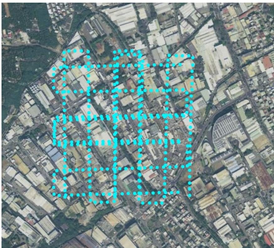
圖 4-3 南崗 UAS 小像幅像片拍攝中心
