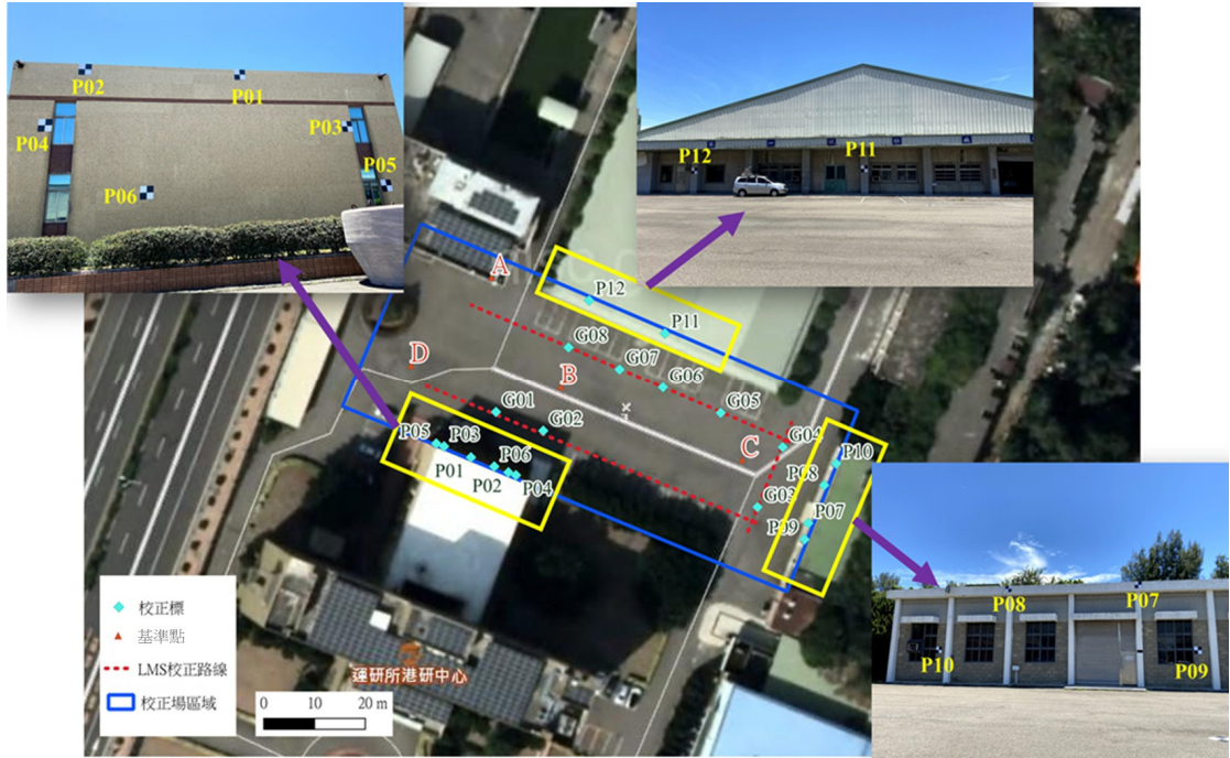
圖 1 本實驗室車載光達校正場示意圖
