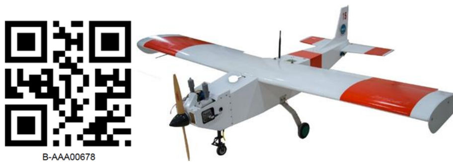
圖 2-1 國土測繪 1 號定翼型 UAS 及註冊碼
