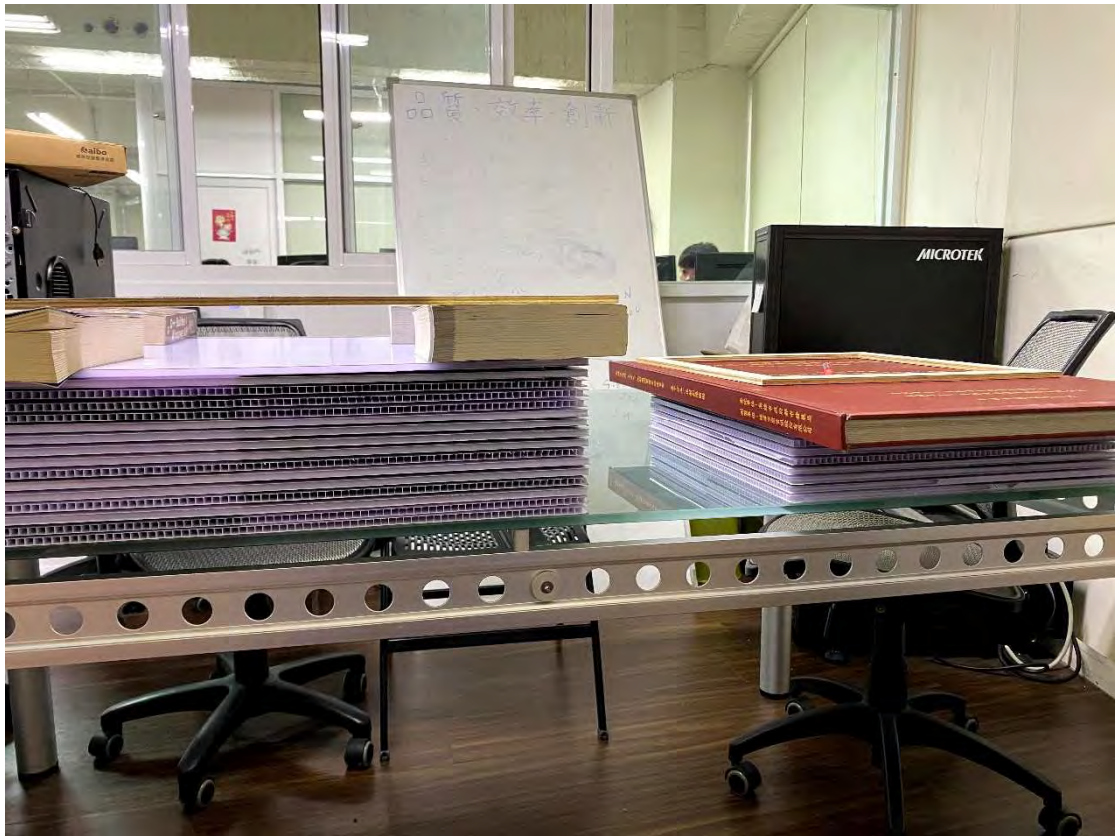
圖 3-41 校正標背面貼附磁鐵後以重物施壓並放置 24 小時
