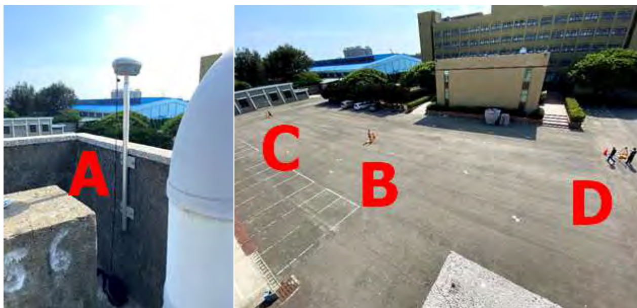
圖 4-18 校正標坐標參考值量測作業－固定點衛星定位測量
