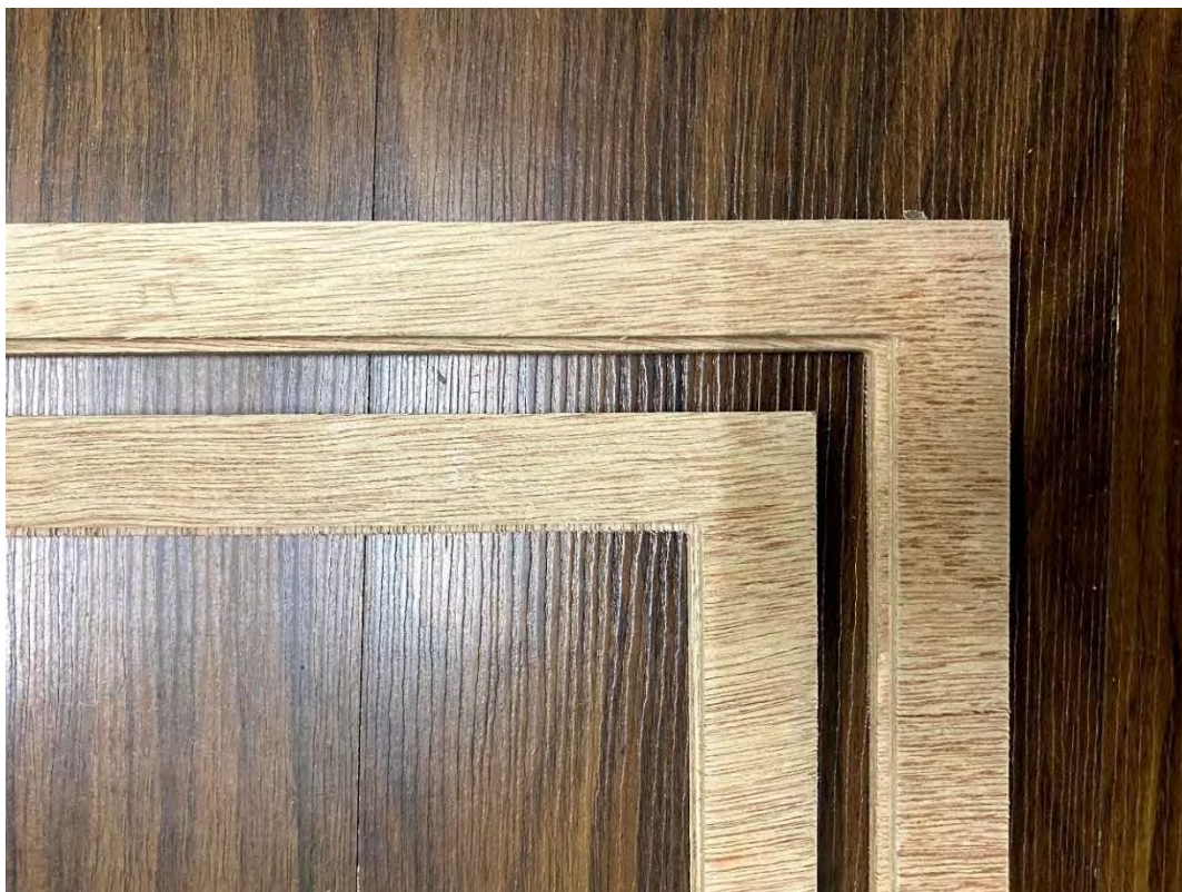
圖 3-38 貼附磁鐵輔助木框—細部檢視 2.5mm 之尺寸差異
