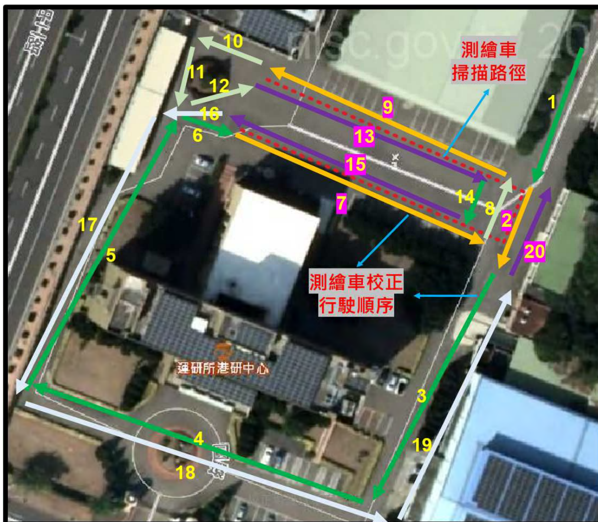
圖 3-11 光達測繪車於掃描路徑行駛順序示意圖 (路線 1)
