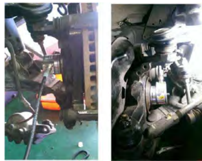
圖 2-8 輪速計安裝情形
