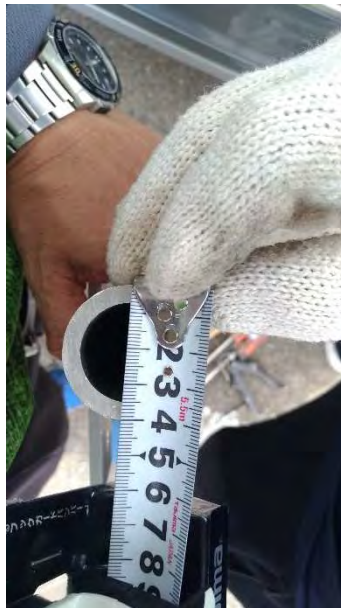
圖 3-64 GNSS 靜態基站鋁管管壁厚度
