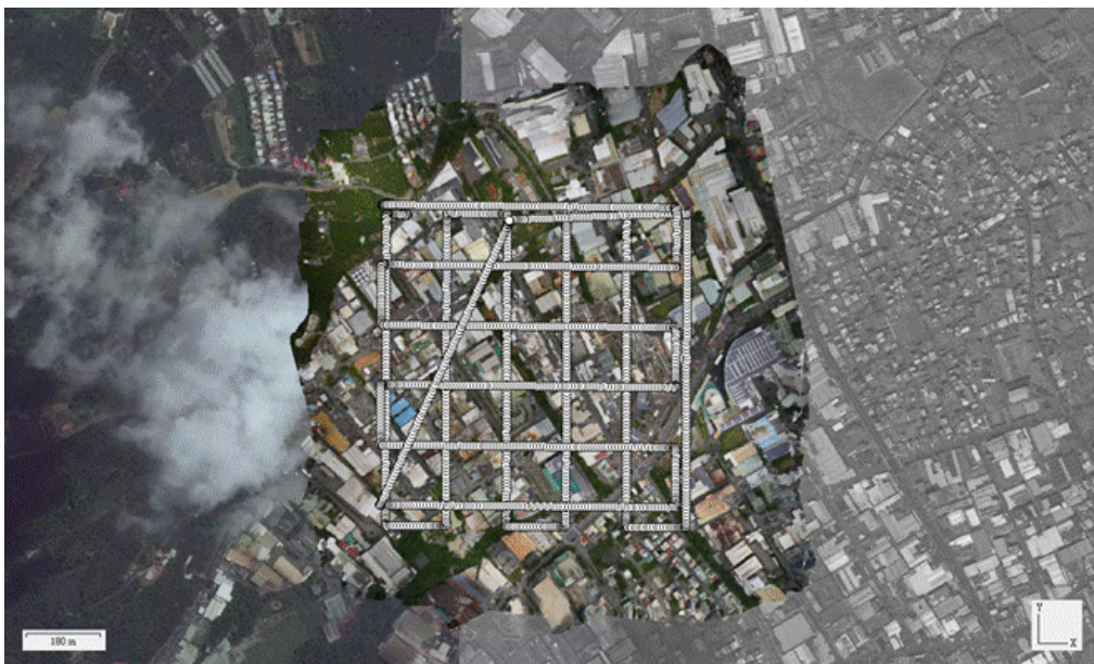
圖 參-2 南投南崗校正場飛行航線規劃
