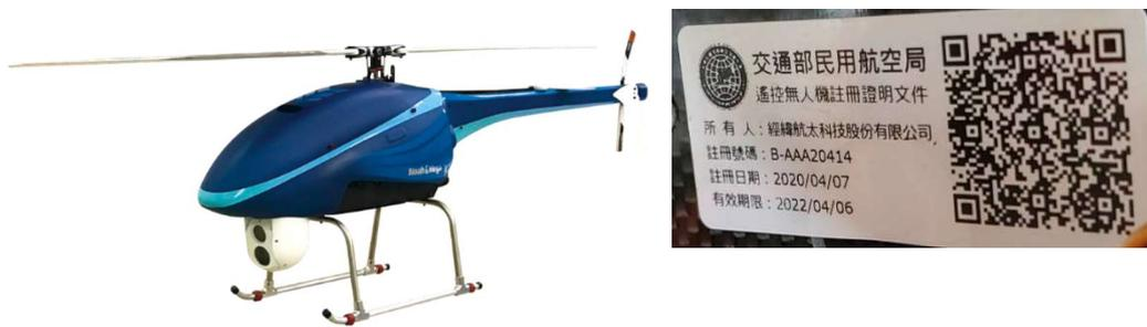
圖 貳-2 單旋翼型 UAS
