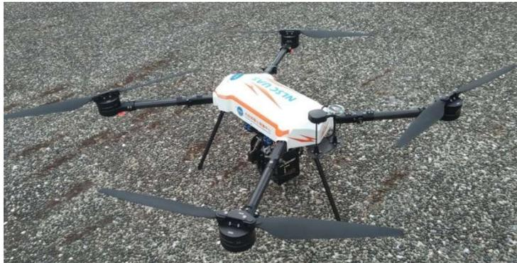
圖 貳-1 多旋翼型 UAS
