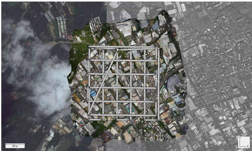
圖 參-2 南投南崗校正場飛行航線規劃
