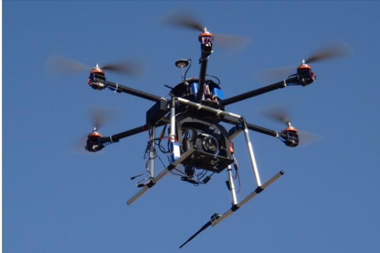
圖 2-5 多旋翼型 UAS
