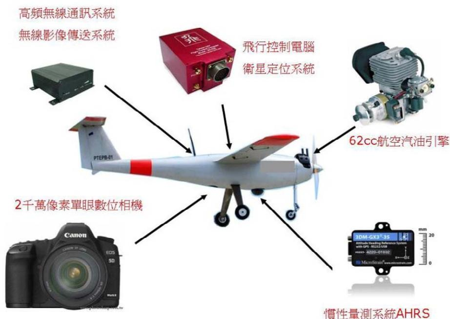
圖 2-3 國土測繪一號 UAS 系統架構
