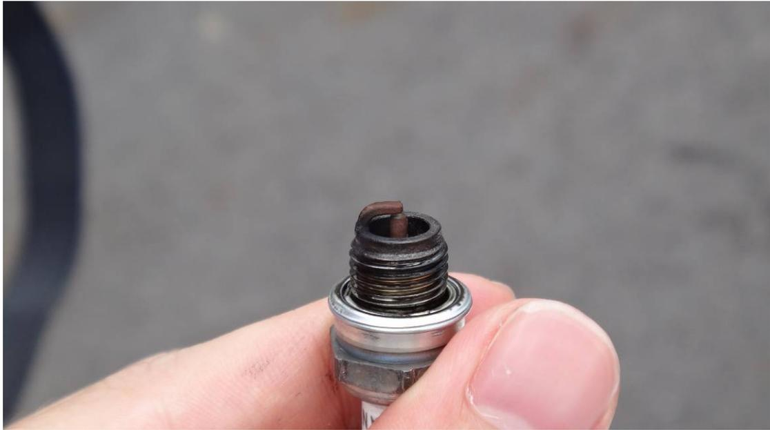
圖 3. 安降後，火星塞照片。火星塞略乾
