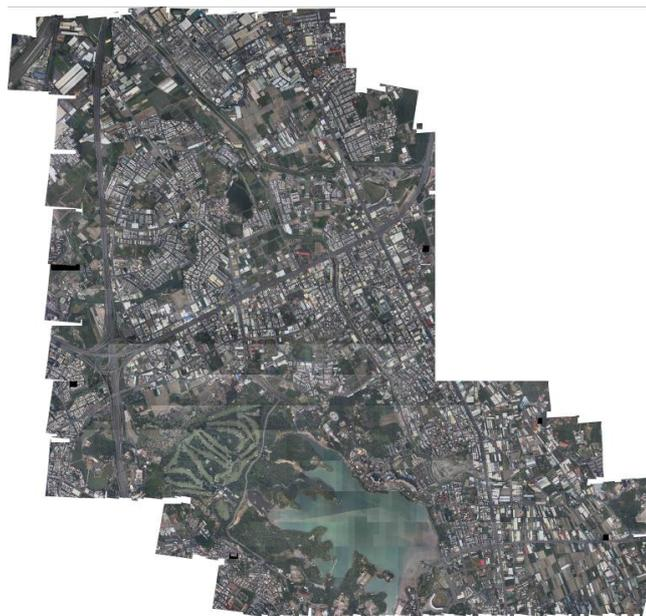
圖 4-64 高雄市仁武區 UAS 影像產製之幾何正射糾正鑲嵌圖
