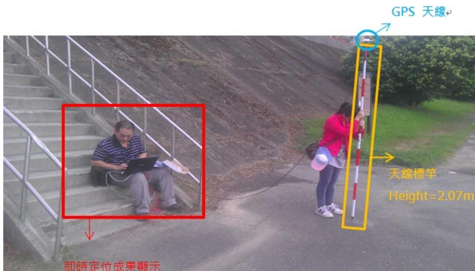
圖 3-10 圖 1 BD970 e-GPS 定位功能”靜置”之實地測試情況
