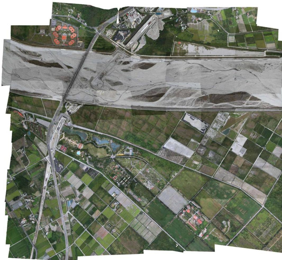
圖 4-117 花蓮壽豐新豐平大橋 UAS 影像產製之幾何正射糾正鑲嵌影像
