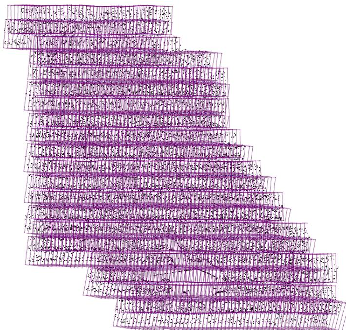
圖 4-60 高雄市仁武區 UAS 影像自率光束法空三平差連結點分布概略圖
