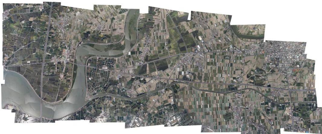
圖 4-94 嘉義縣朴子東石 UAS 影像產製之幾何正射糾正鑲嵌影像
