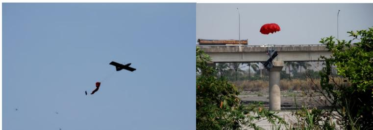
圖 6-2 小型電動 UAV 開傘，並因風力影響掉入河床
