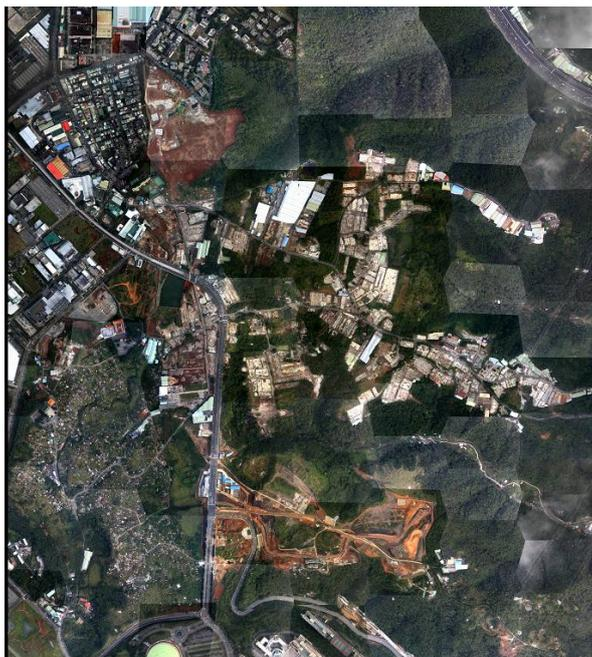
圖 4-75 桃園機場捷運 UAS 影像產製之幾何正射糾正鑲嵌圖
