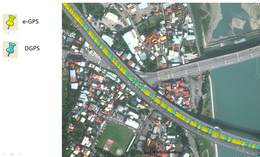
圖 3-16 快速移動下 BD 970 之 e-GPS 與 L1/L2 DGPS 定位成果套疊
