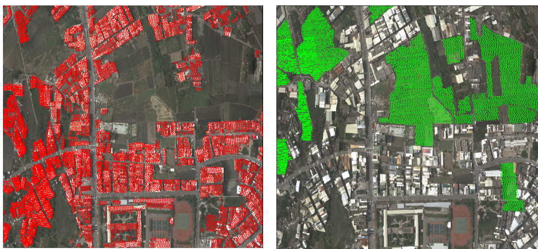
圖 14、LiDAR 輔助土地分類示意圖（左為建築使用、右為農業使用）
