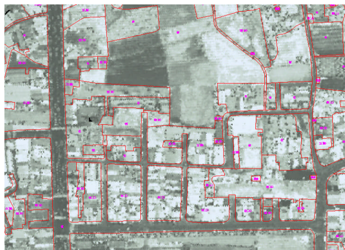
圖 12、套疊 LiDAR Intensity 影像圖數化情形示意圖
