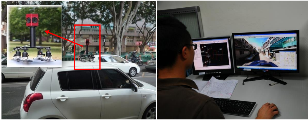
圖 6-1 街景車系統及其內業判釋情形
