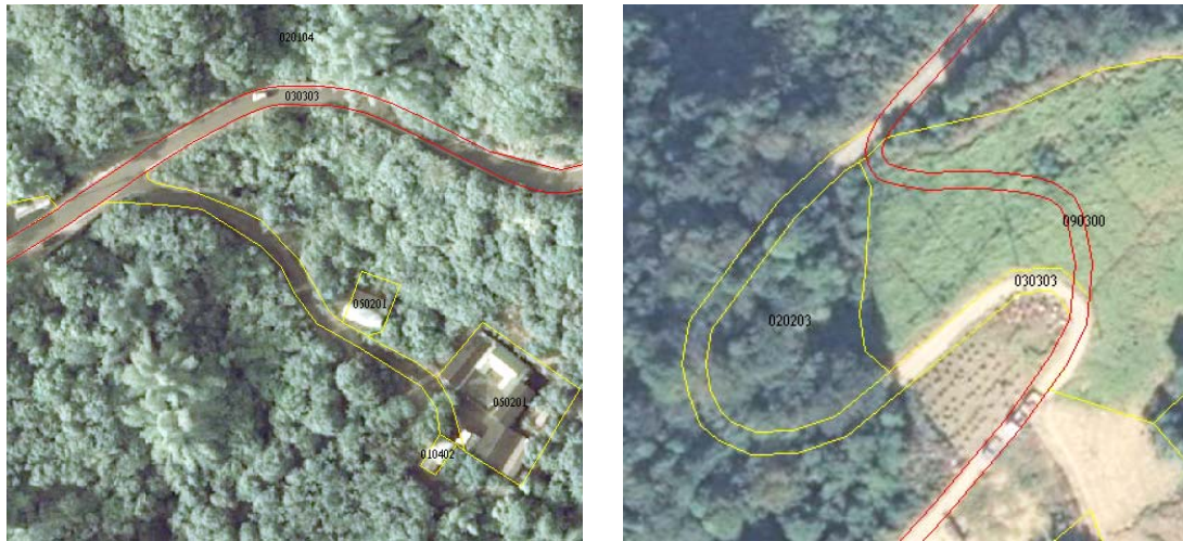
圖 3-4：道路與正射影像形狀不符且明顯不合理--修正(黃線為修正後)
