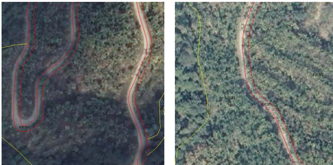
圖 3-3：道路與正射影像形狀相符但位置偏移--不修正
