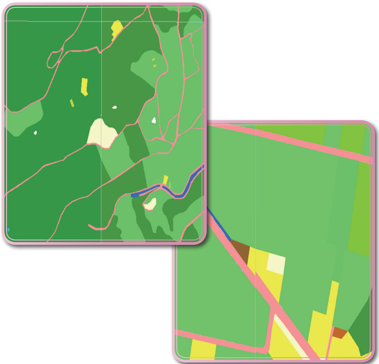
圖33：相鄰圖幅成果疏漏、錯動情況示意圖
