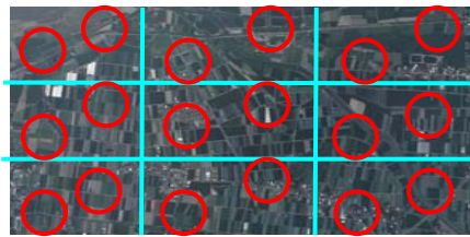
圖 3.3-2 空中三角量測點位示意圖
