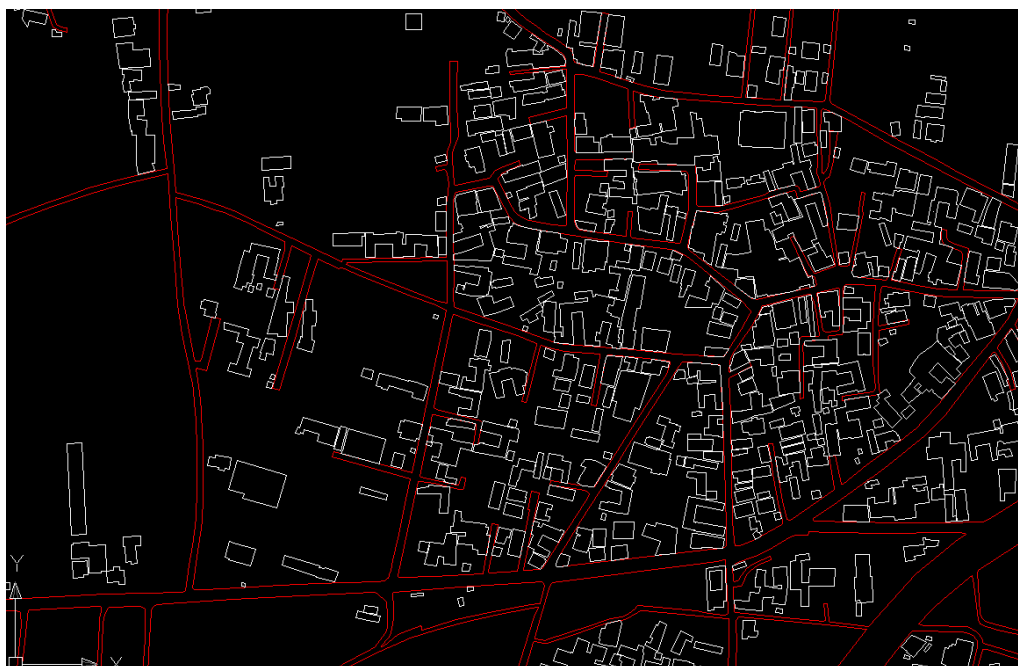
圖 3.6-2 道路及建物圖層立體測繪結果示意圖
