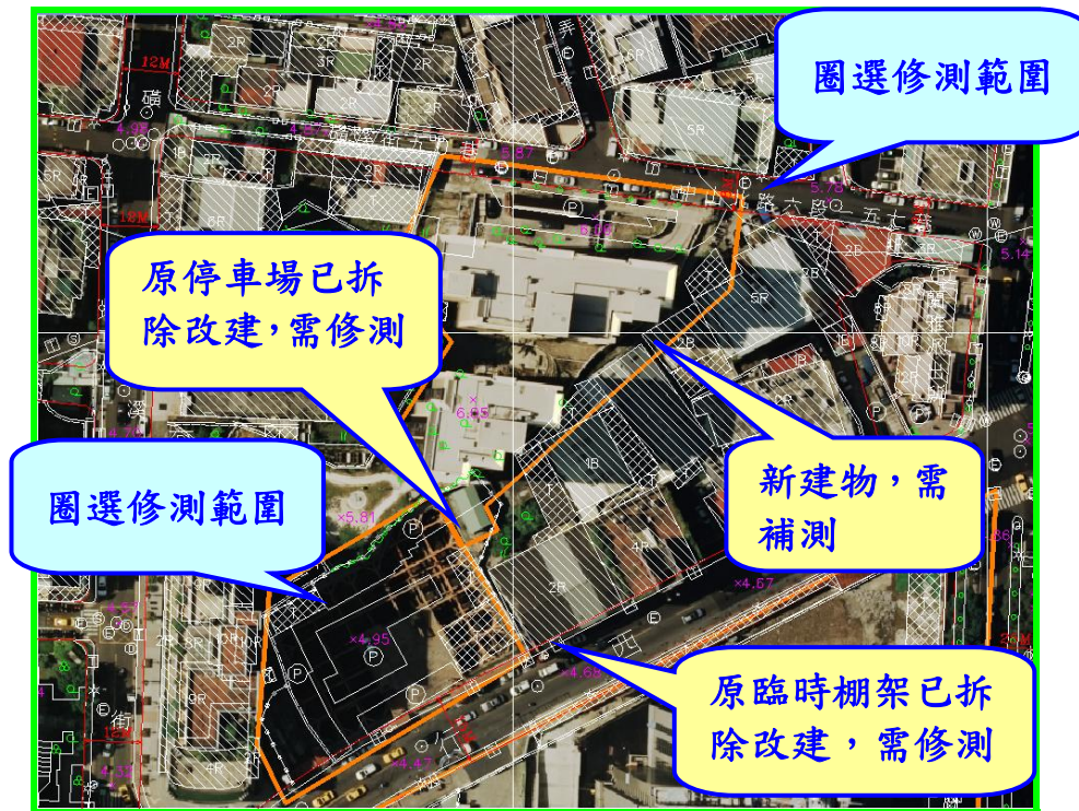
圖 2.4-2 將待修測圖資套疊初始正射影像以圈選修測區
