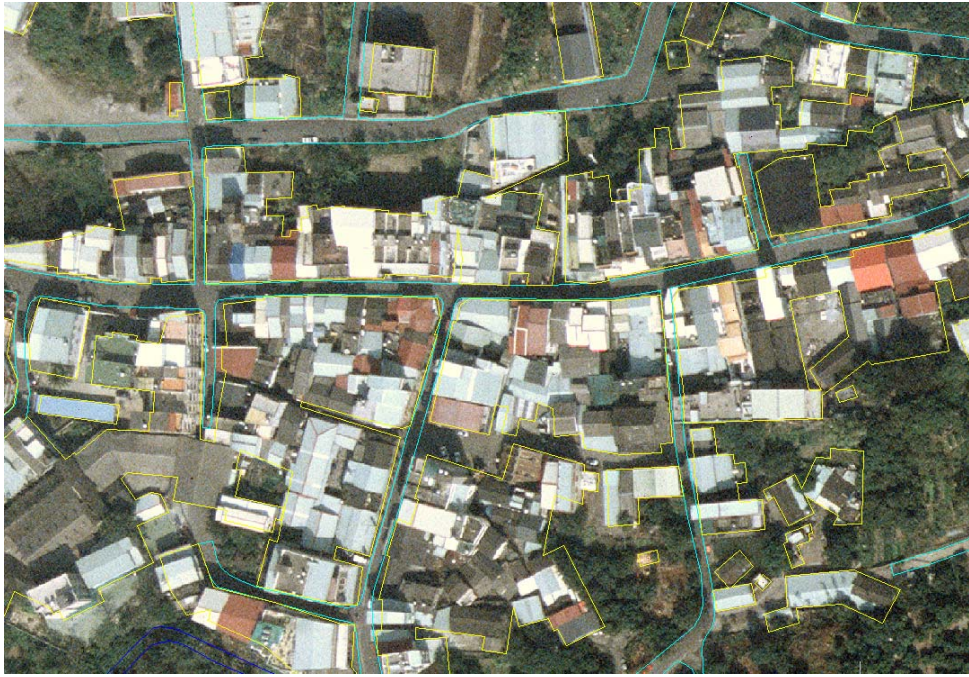
圖 5.17 道路邊線以臨街建築線繪製示意圖
