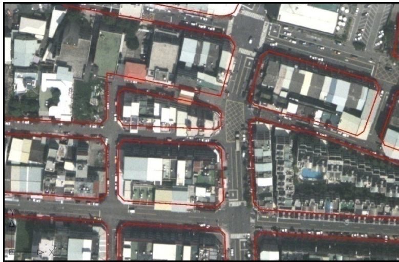
圖 4.9 路邊線以臨街建築線繪製示意圖
