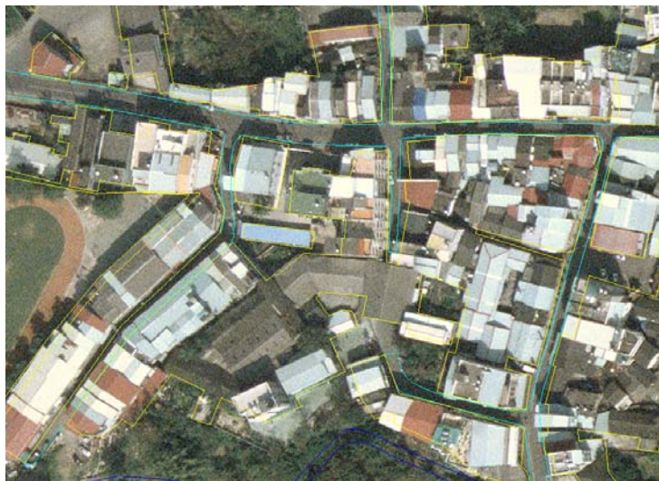
圖 5.25 建物密集區立體測圖成果示意圖
