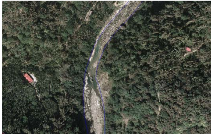
圖 5.19 水系立體測圖成果示意圖
