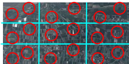
圖 5.2-1 空中三角量測點位示意圖
