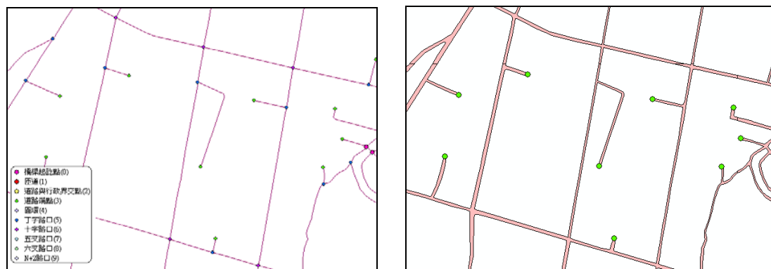
圖 4.7-1 道路中線端點應落於道路面邊界
