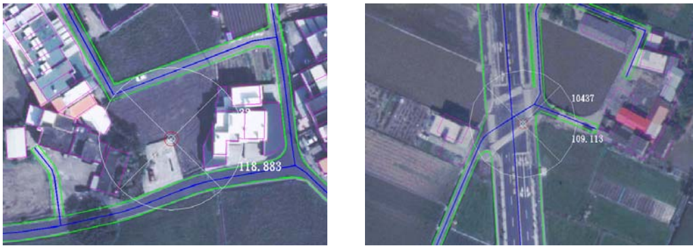
圖 4.6-3 以航測特徵點檢核正射影像範例
