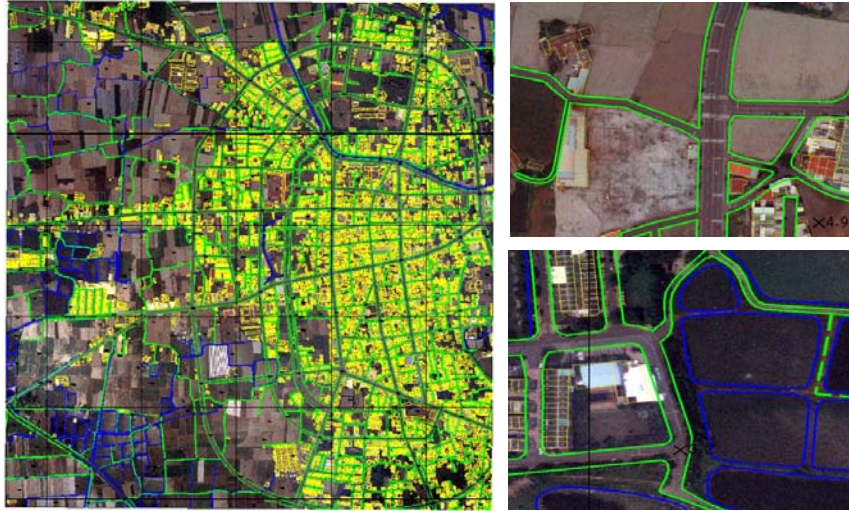
圖 4.6-2 正射影像套疊向量檔成果範例
