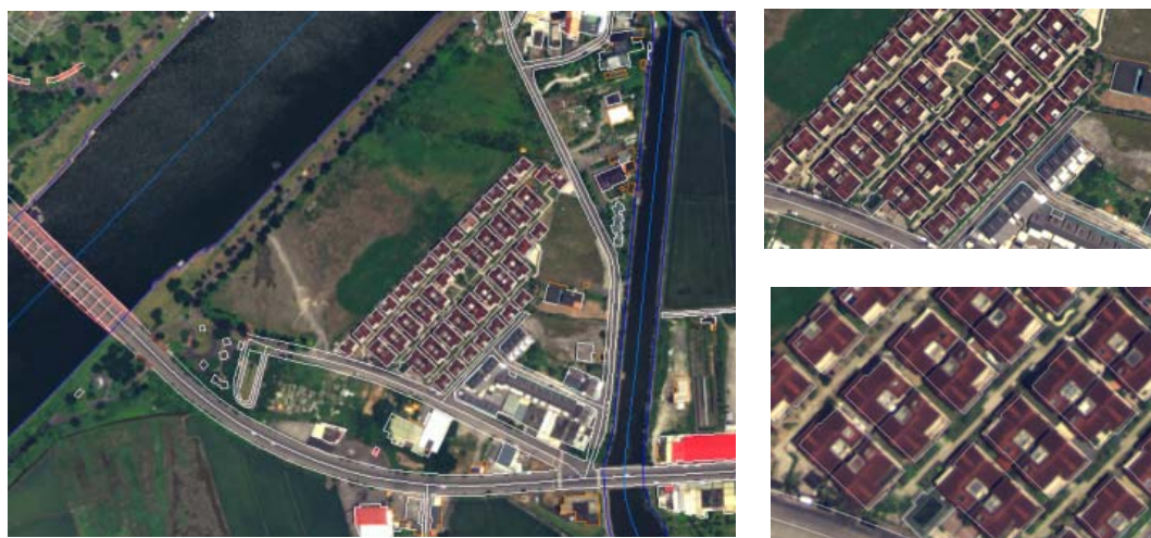
圖 4.6-4 正射影像套疊向量檔成果範例
