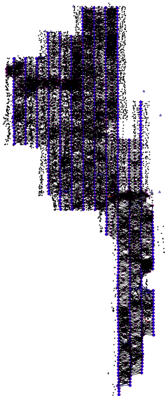
圖 3.7-3 航帶間 5 重點以上之空三點轉點網形圖(宜蘭地區)
