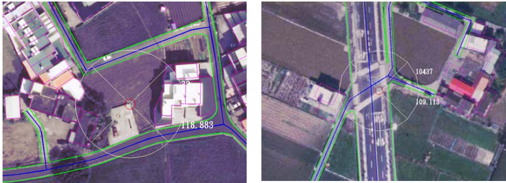
圖 4.6-5 以航測特徵點檢核正射影像範例
