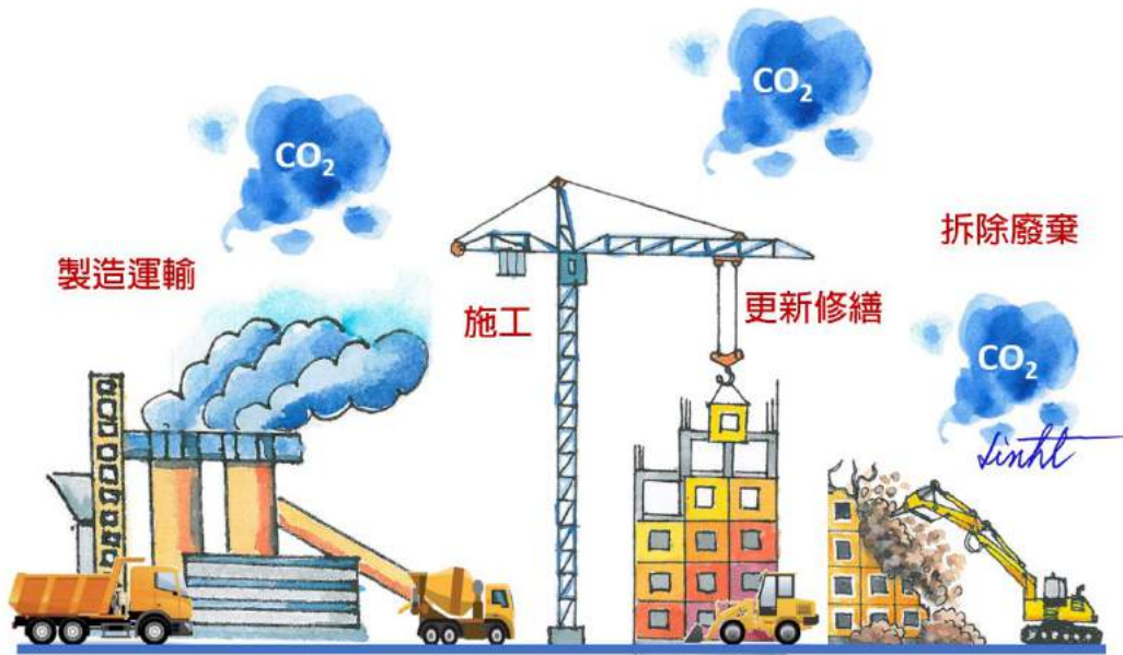
圖 12 蘊含碳排 EC 之製造運輸、施工、更新修繕、拆除廢棄等四階段評估 (林憲德繪圖)
