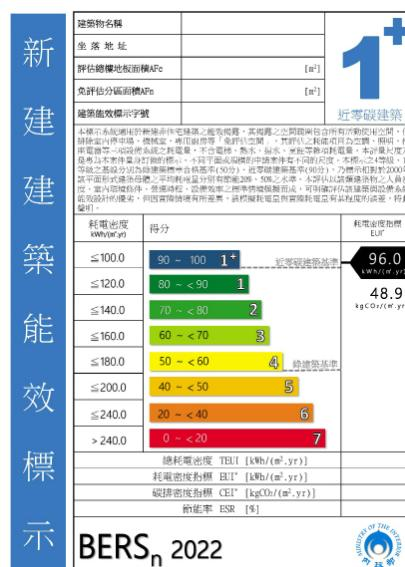
圖2-4-3 建築能效評估法依其得分可同時取得對應等級之建築能效標示（上圖為近零碳建築等級之範例）
