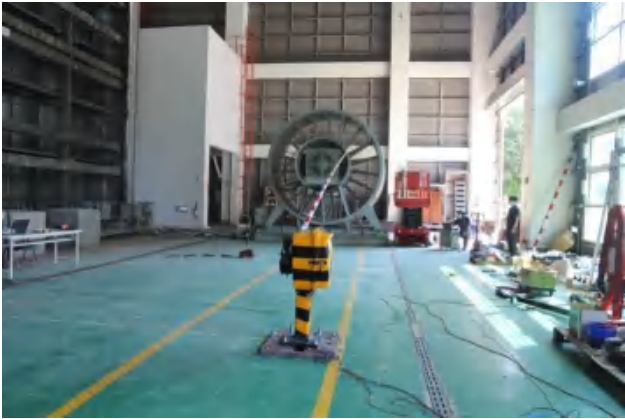
圖 3-4-13. 鐵路平交道遮斷器耐風試驗
