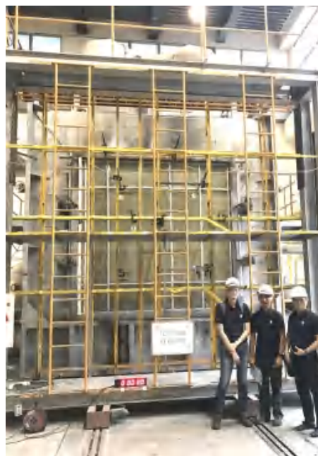
圖 2-3- 1. TÜV SÜD PSB 見證試驗-非承重牆耐火性
