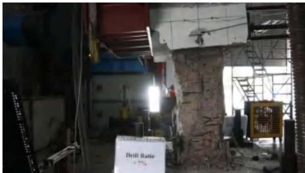
圖 3-1- 1. 受火害高強度鋼筋混凝土柱試體之反覆載重實驗
