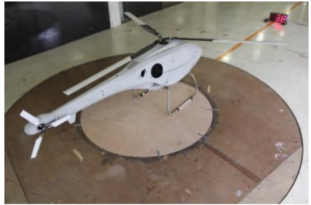
圖 3-4-9. 無人直昇機耐風風洞試驗
