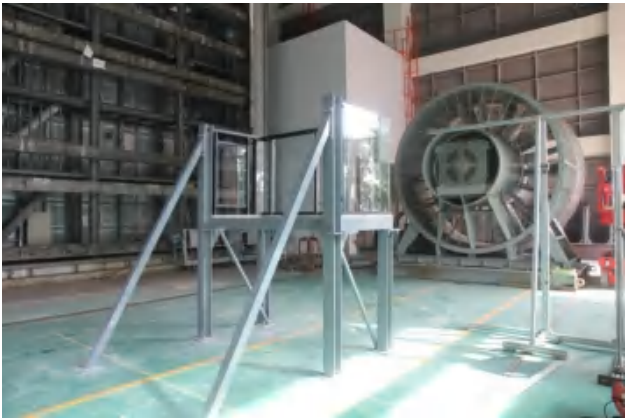
圖 3-4-14. 玻璃型陽臺欄杆耐風試驗
