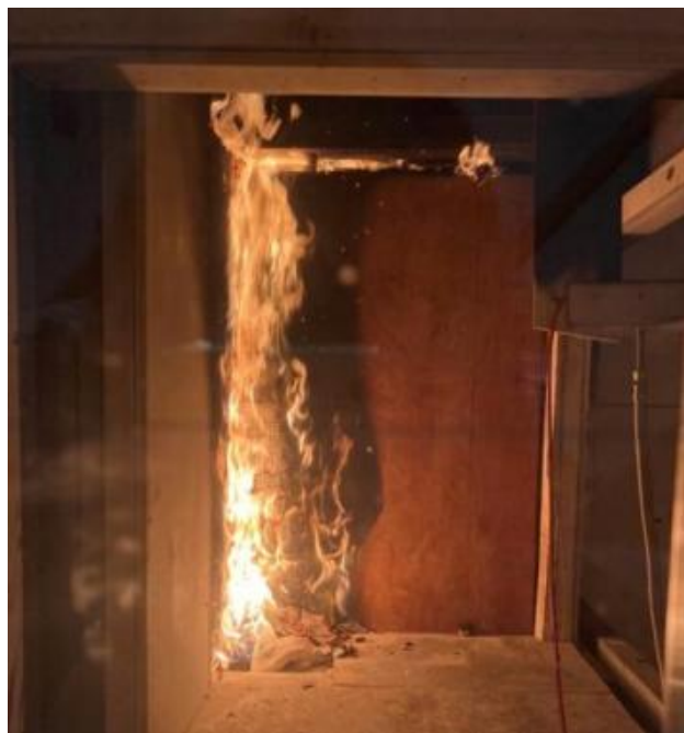
圖 3-1-4. SBI 單材耐燃試驗
