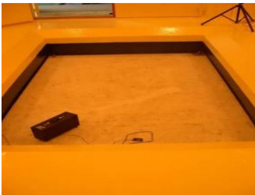
圖 3-2-2. 樓板衝擊音隔音性能試驗
