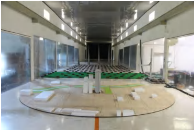
圖 3-4-8. 建築結構風載重試驗
