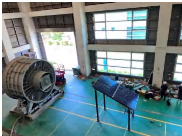
圖 2-1-8. 太陽能光電板實尺寸耐風試驗
