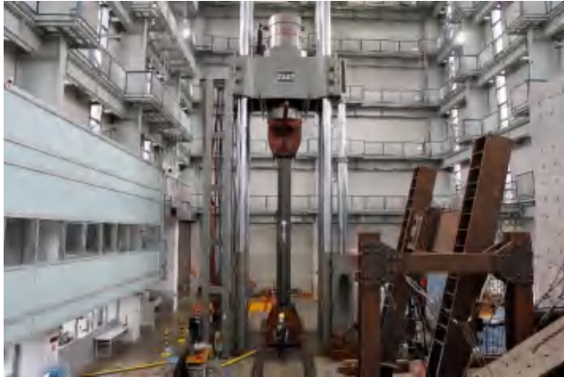
圖 3-3-1. 實尺寸挫屈束制斜撐性能試驗(3,000 噸油壓試驗機)
