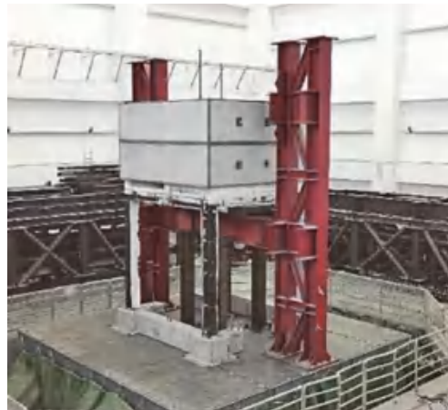
圖 4-4-13. 構架屋振動台實驗配置
