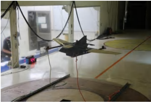
圖 3-4-7. 無人機耐風風洞試驗
