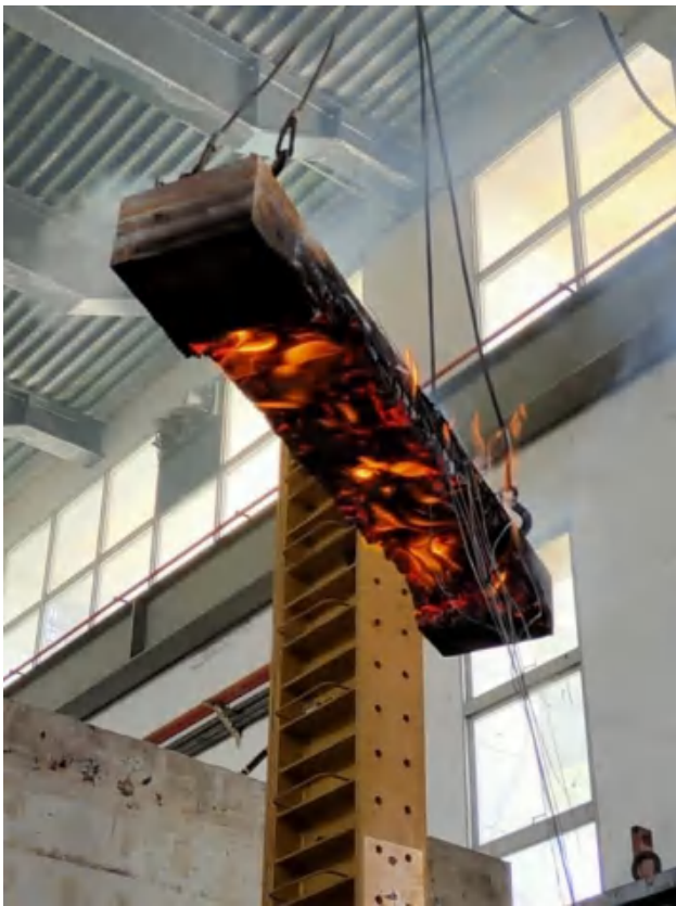
圖 3-1-5. 水平樓板加熱火害實驗
