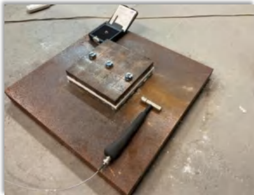
圖 3-2-3. 橡膠緩衝材動態剛性試驗
