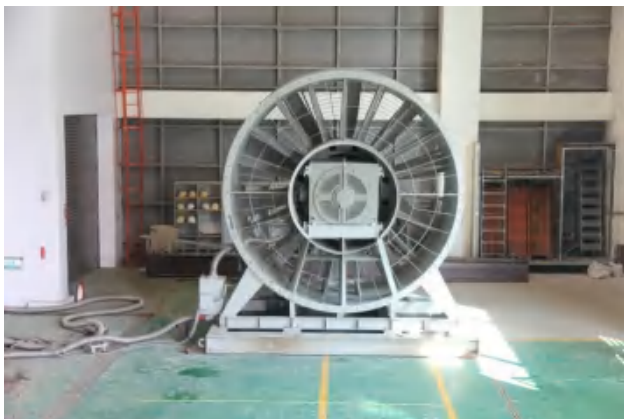
圖 3-4-5. 本所 17 級風造風設備
