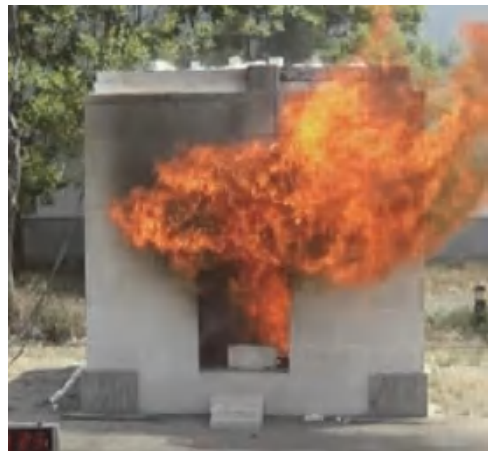
圖 4-4-12. 構架屋火害實驗(完全燃燒階段)
