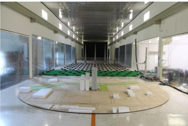
圖 3-4- 8.建築結構風載重試驗
