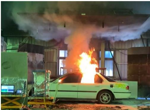
圖 2-1- 6.自動撒水設備對汽車火災滅火實驗
