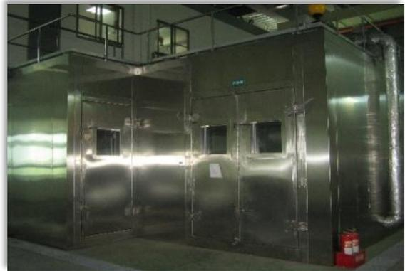
圖 3-2- 4.全尺寸建材逸散檢測試驗艙
