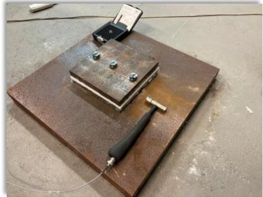
圖 3-2- 3.橡膠緩衝材動態剛性試驗
