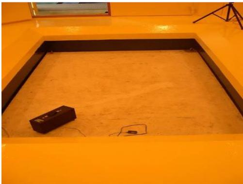
圖 3-2- 2.樓板衝擊音隔音性能試驗
