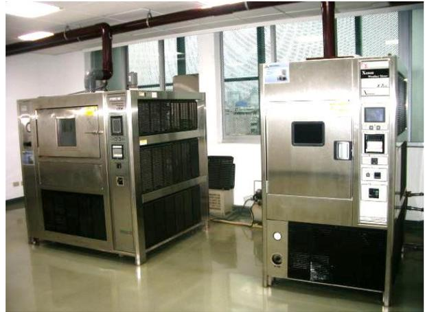
圖 3-3-3.氙弧燈式耐候試驗機及鹽霧試驗機
