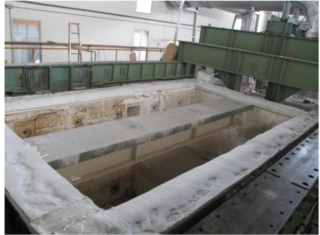
圖 3-1- 10.噴覆式防火被覆的鋼梁
