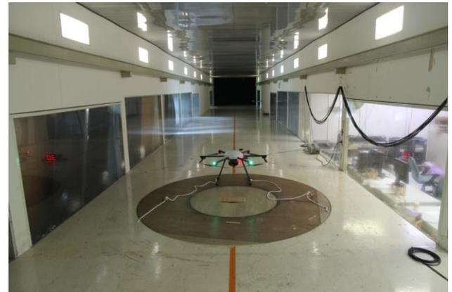
圖 3-4-6. 空拍機耐風風洞試驗
