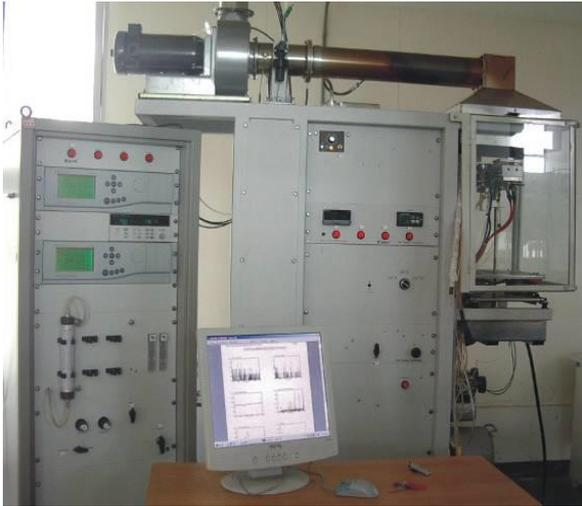
圖 3-1- 3.耐燃與煙流率試驗設備
