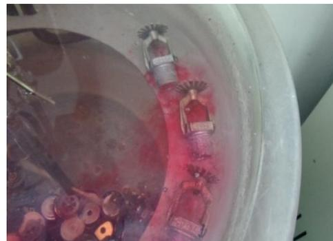
圖 4-4- 3.老舊撒水頭動作溫度試驗
