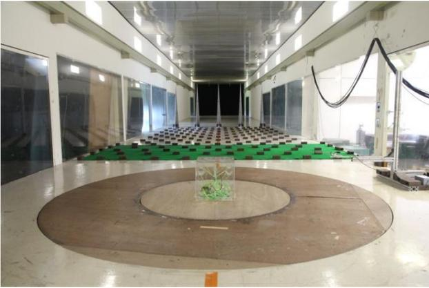
圖 3-4- 7.建築外表披覆物風壓試驗
