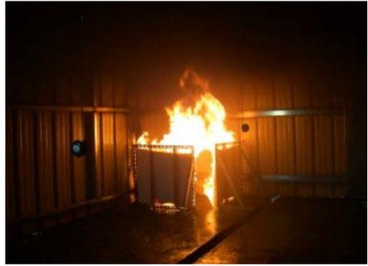
圖 2-1- 7.小水量自動撒水設備之撒水頭滅火性能實驗 (ISO 6182-10)
