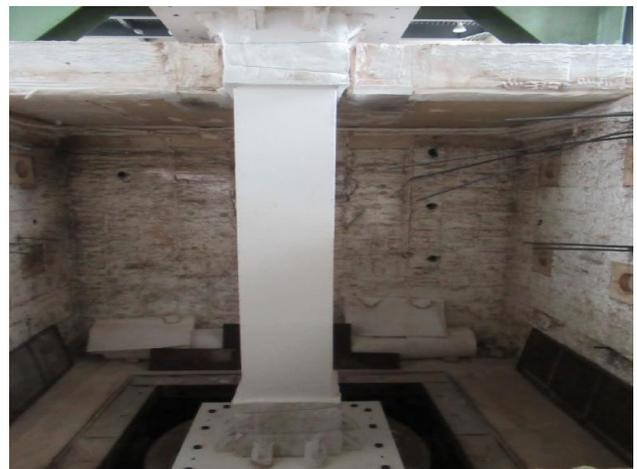
圖 3-1- 11.膨脹型防火漆的鋼柱
