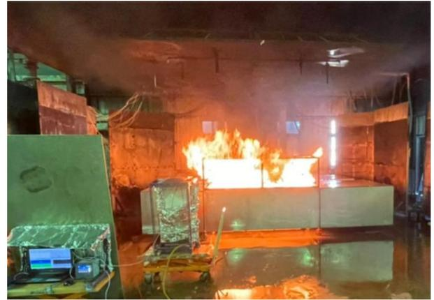
圖 4-4- 6. 撒水設備滅火實驗
