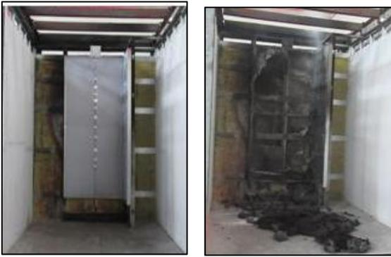
圖 4-4- 2.試體一加熱試驗前及加熱試驗後
