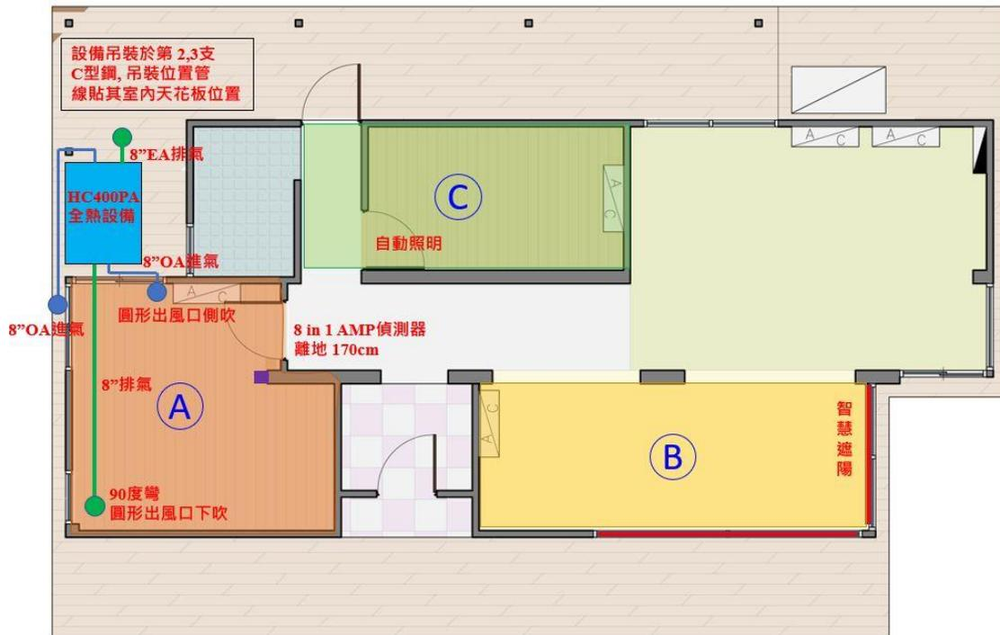
圖 2-2 實驗屋室內環控設備配置平面圖
