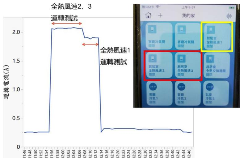
圖 4-28 全熱交換機三段風速切換運轉用電測試
