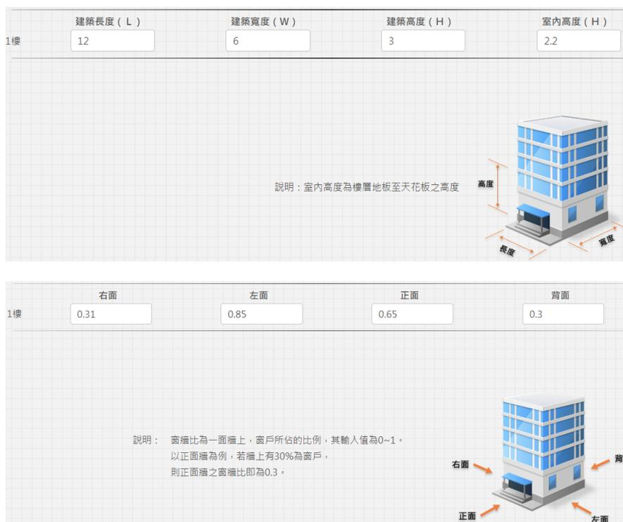
圖 4- 35 建築外觀設定尺寸與窗牆比之示意畫面
