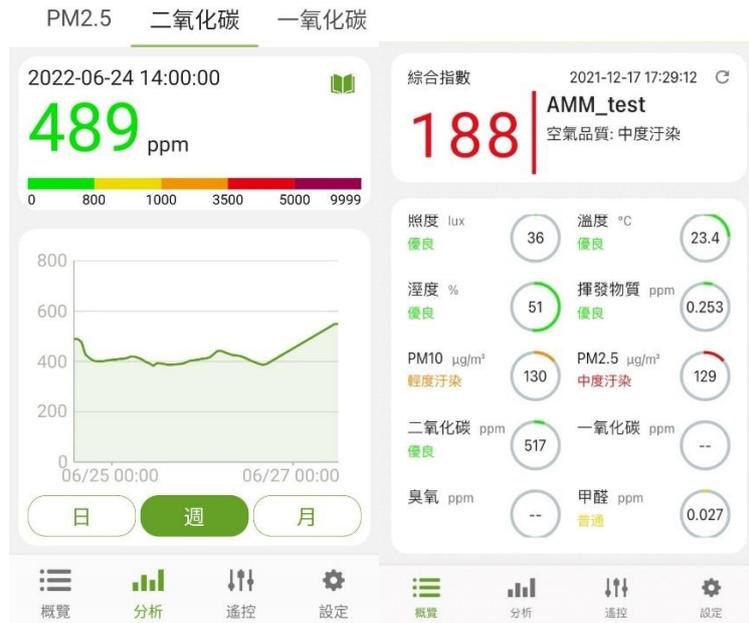
圖 4-25 全熱交換器運轉測試期間，A 區室內偵測參數變化
