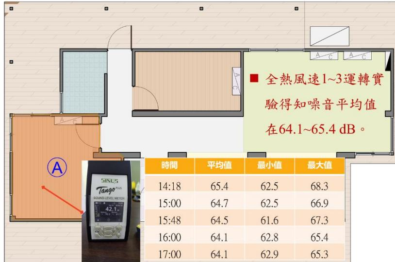
圖 4-29 房間場域量測三段風速運轉之室內噪音值
