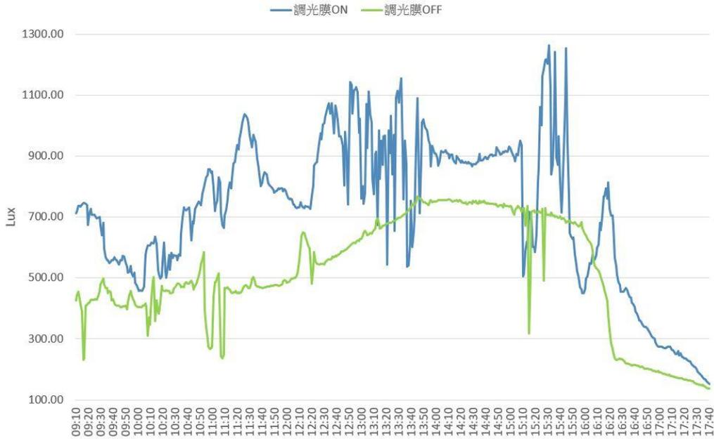
圖 4-1 調光膜狀態對照度影響之量測結果
