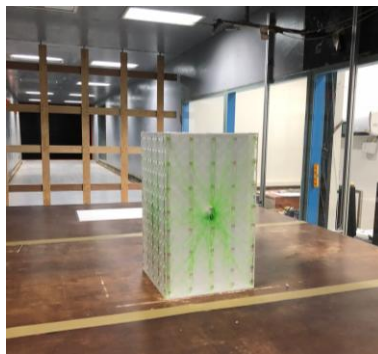
圖 2-3 具有四面多孔性外牆建築模型，可變化更換外牆以變化牆間距、側邊開放性及開孔率
