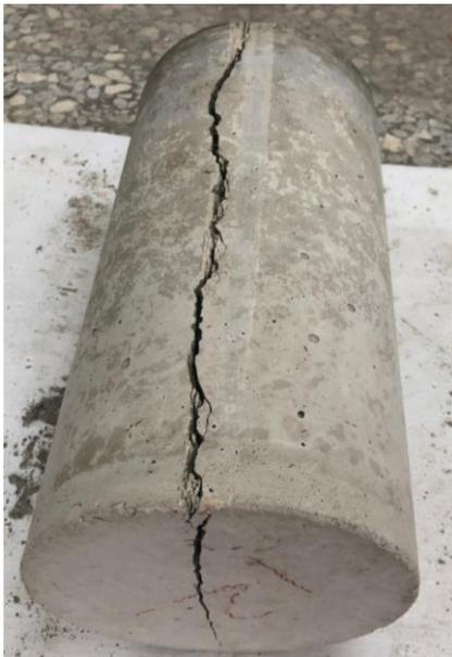
圖4-27 爐石粉混凝土 SS15P15
