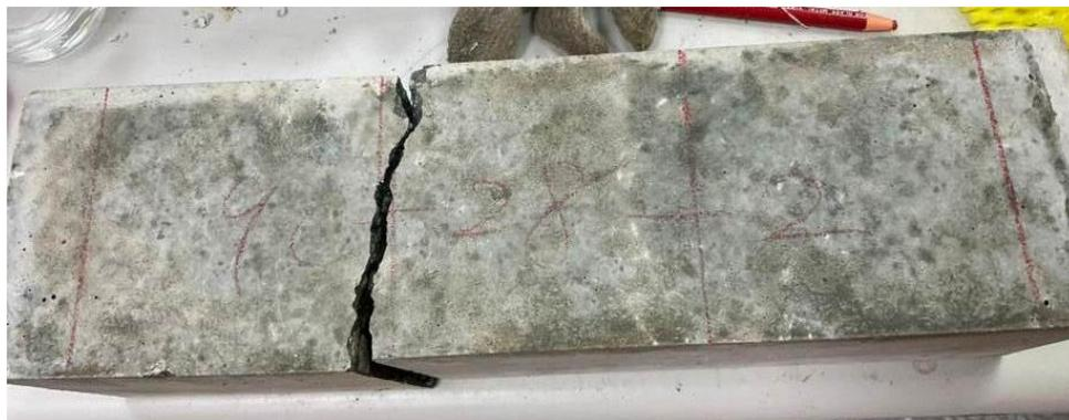
圖4-20 爐石粉混凝土 SS00P00抗彎破壞
