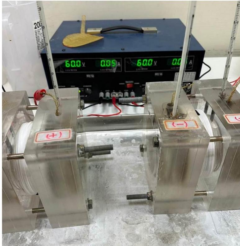
圖3-27 快速氣離子穿透試驗儀試體安裝
