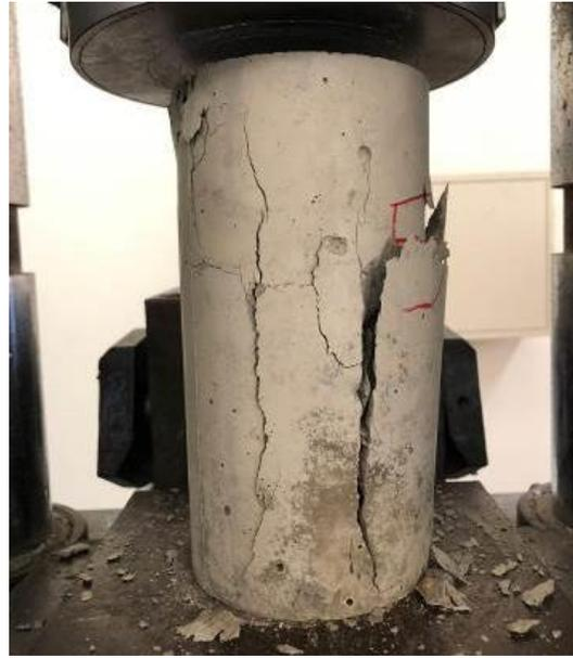
圖 4-11 飛灰混凝土 FS00P00
