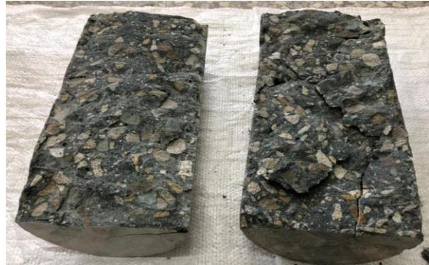
圖4-17 爐灰混凝土 MS00P00
