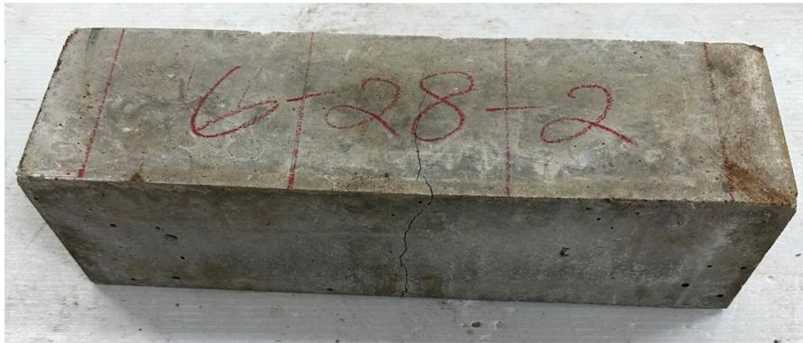
圖4-30 飛灰混凝土 FS30P00抗彎破壞
