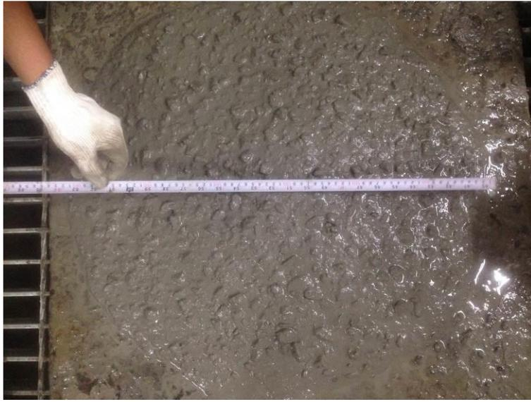
圖4-3 混凝土 HS30P00坍流度
