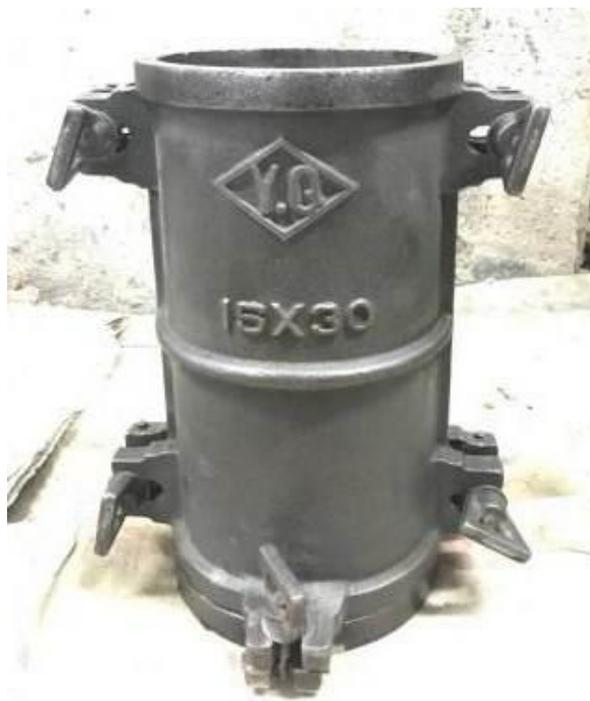
圖3-8 劈裂試驗試體模具
