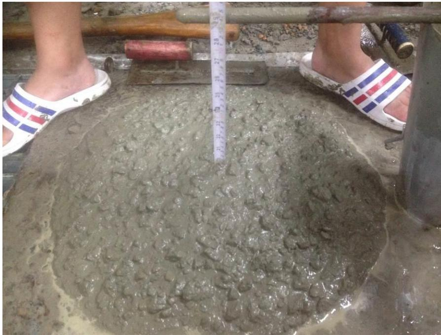
圖3-10 新拌混凝土坍度試驗
