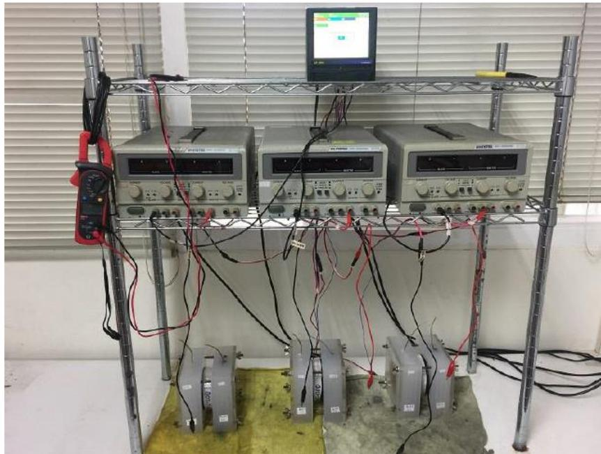
圖3-18 快速氣離子穿透試驗儀
