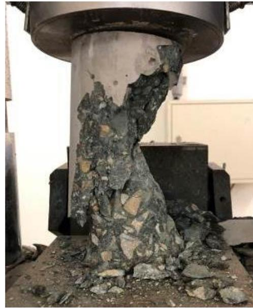
圖4-13 爐灰混凝土 MS00P00
