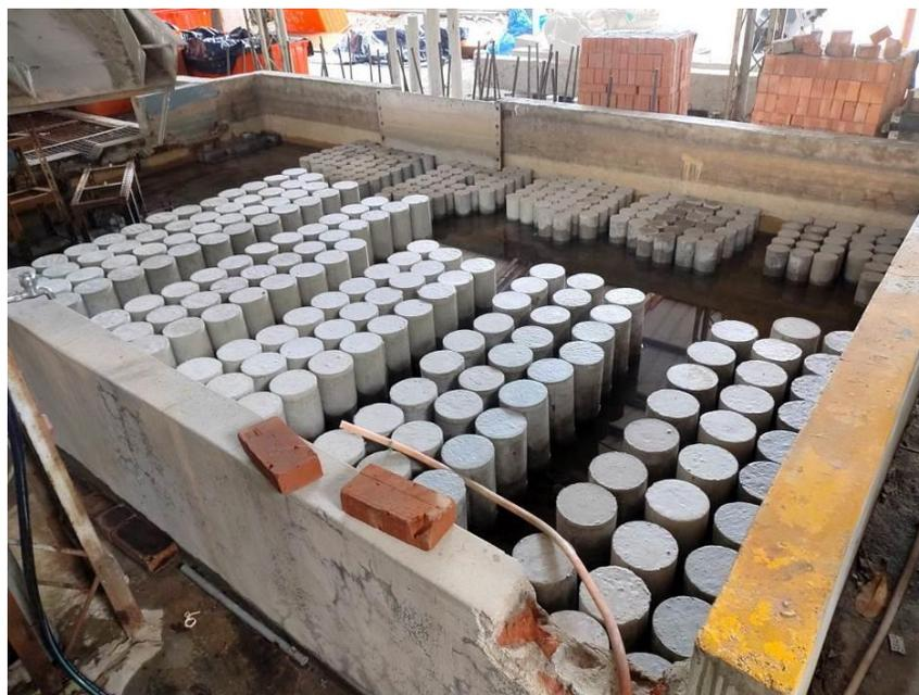
圖3-5 淡水養護試體
