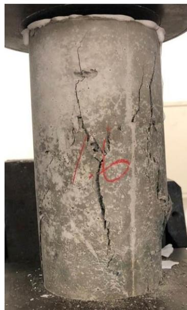
圖4-24 爐灰混凝土 MS15P15
