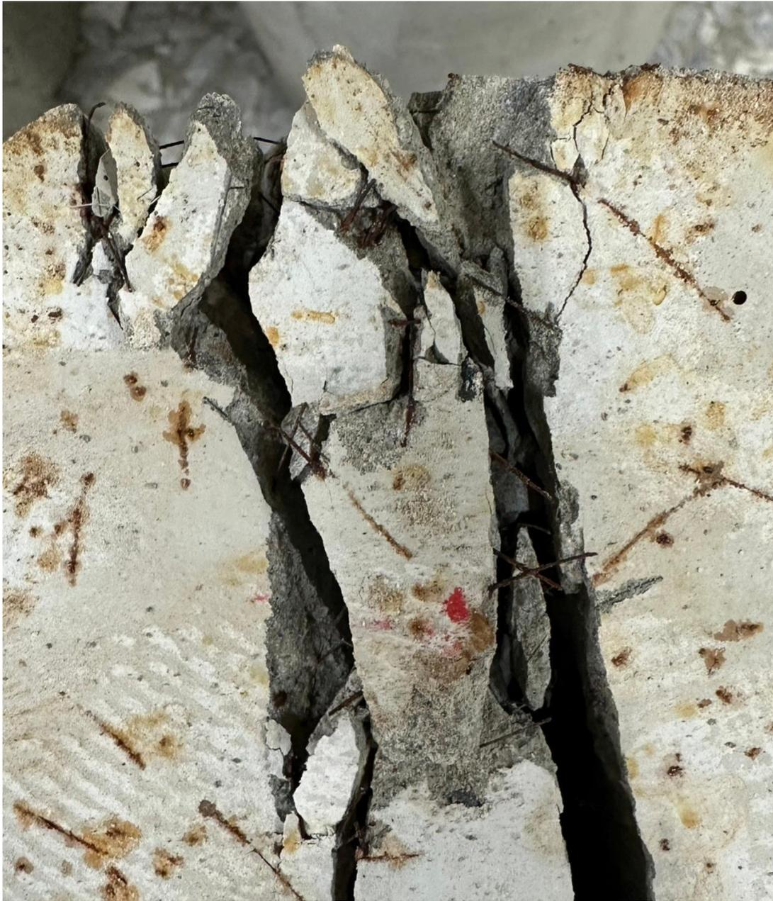
圖4-32 經鹽水養護之鋼纖維混凝土生鏽狀況
