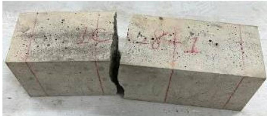
圖4-18 水泥混凝土 CS00P00抗彎破壞
