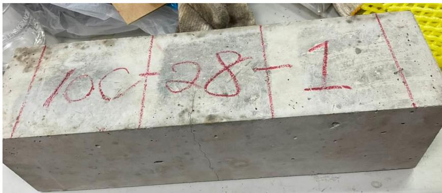
圖4-31 爐石粉混凝土 SS30P00抗彎破壞
