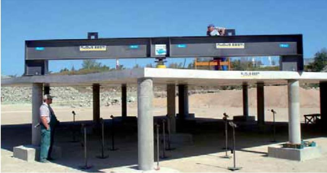
圖2-10 洛克卡塔(Rocca tower)無梁版荷載試驗
