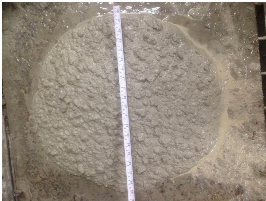
圖3-11 新拌混凝土坍流度試驗
