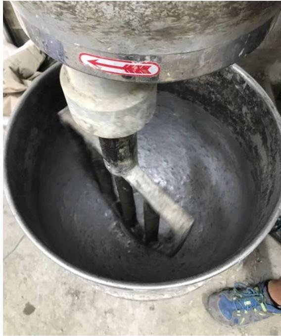
圖3-14 混凝土單軸拌和機（資料來源：本研究整理）
