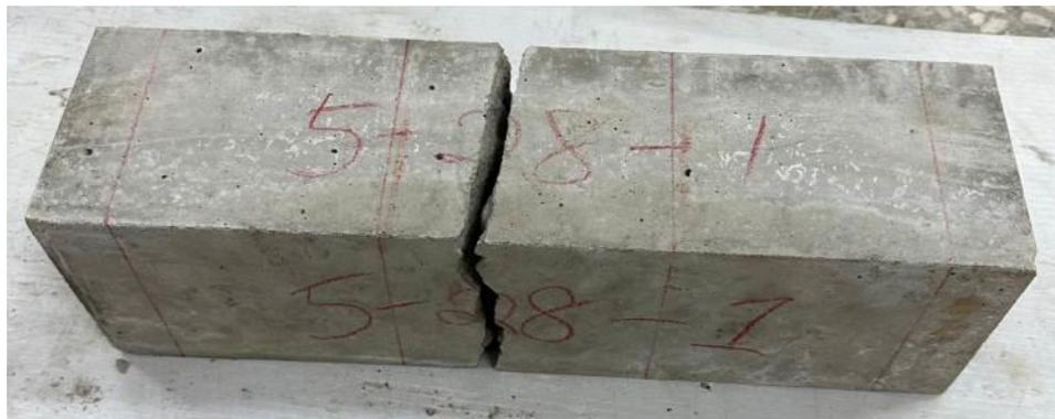
圖4-19 飛灰混凝土 FS00P00抗彎破壞
