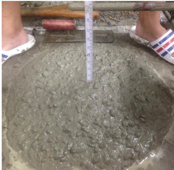
圖4-1 混凝土 CS30P00坍度
