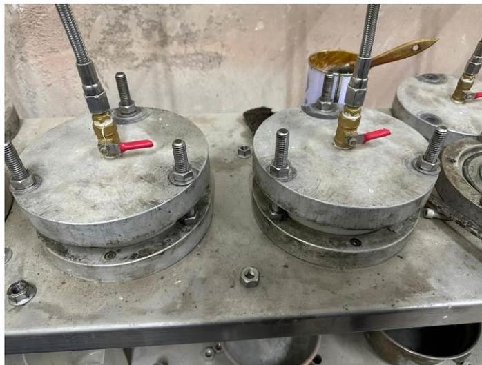
圖3-24 混凝土滲透試驗
