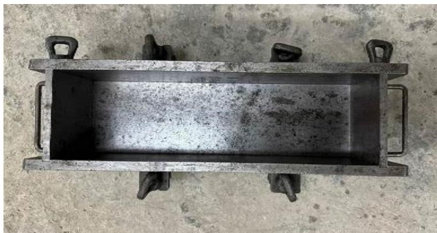
圖3-9 抗彎試驗試體模具
