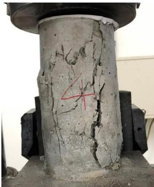
圖4-21 水泥混凝土 CS15P15
