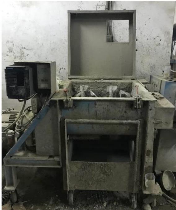
圖3-15 強制式水平雙軸拌和機（資料來源：本研究整理）
