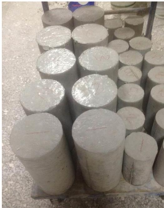
圖3-13 拆完模後之試體
