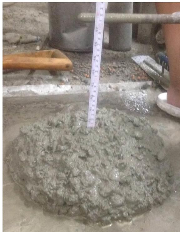
圖4-2 混凝土 CS00P30坍度
