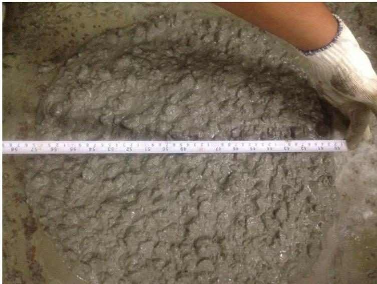
圖4-4 混凝土 HS00P30坍流度
