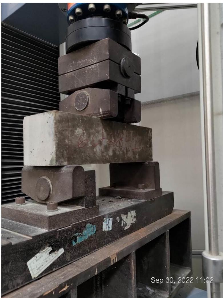
圖3-22 混凝土抗彎強度試驗
