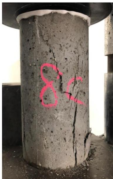
圖4-22 飛灰混凝土 FS15P15
