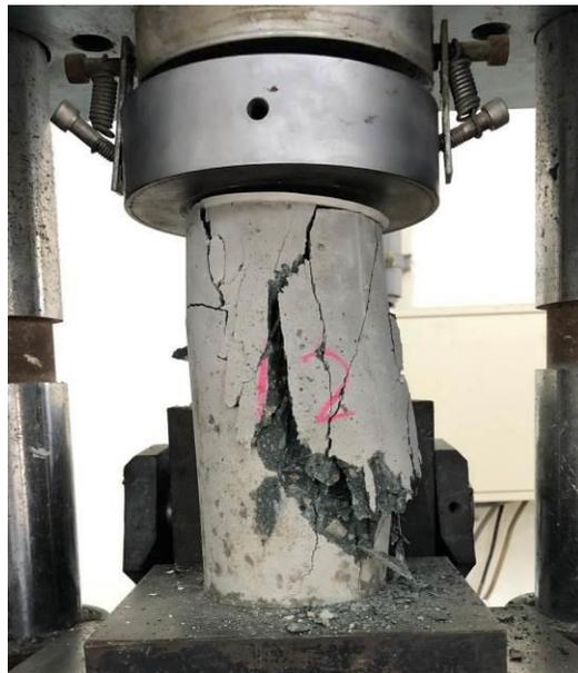
圖3-21 混凝土抗壓強度試驗
