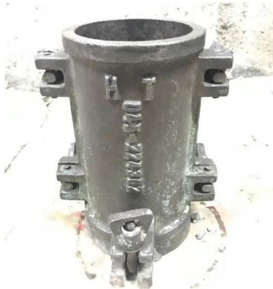
圖3-7 抗壓試驗試體模具
