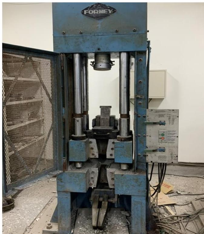
圖3-16 萬能材料試驗機 (資料來源：本研究整理)
