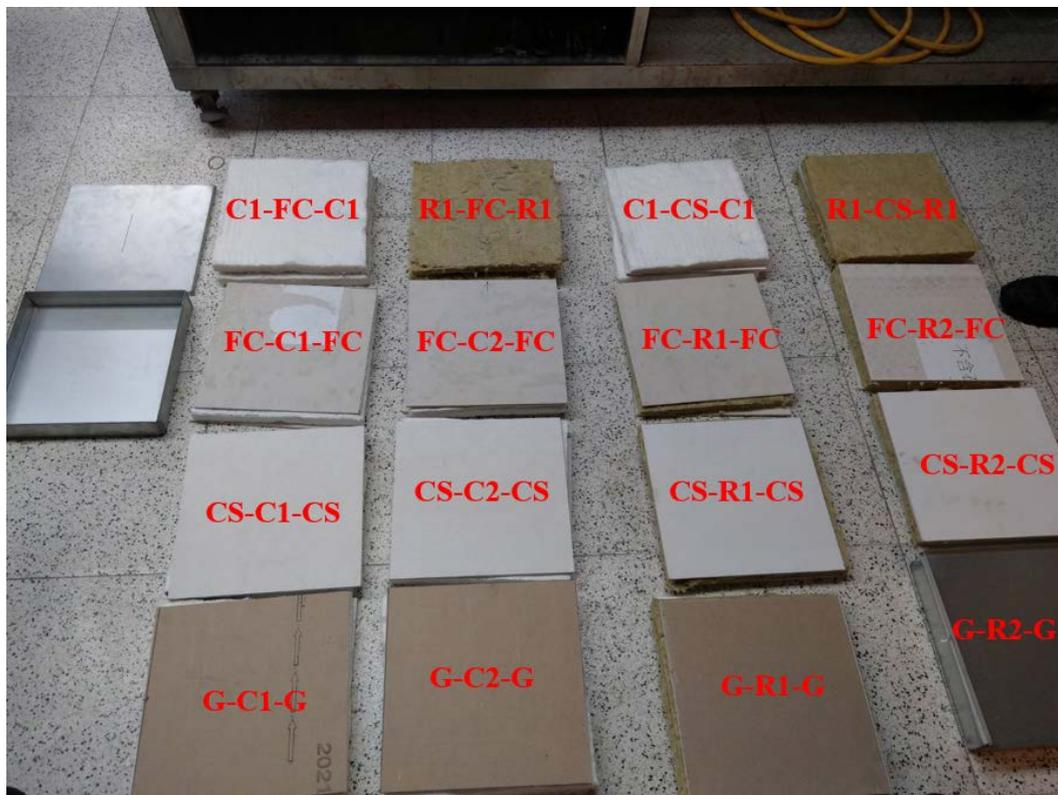
圖 4-6 試體內部中心材及層間材
