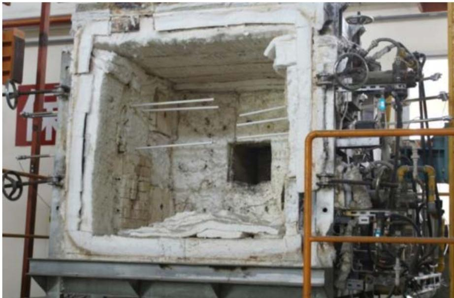
圖 4-1 小型門牆耐火加熱爐
