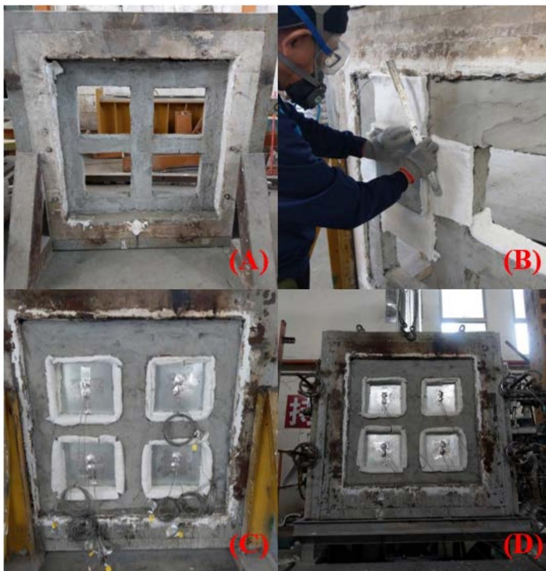
圖 4-7 試體架設過程
