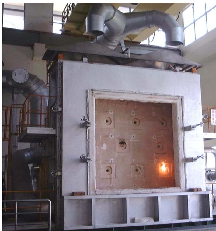
圖 4-2 門牆耐火加熱爐
