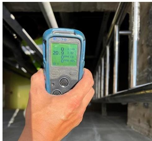
圖 2-14 監測設備裝設作業之抽排風設備與氣體探測器
