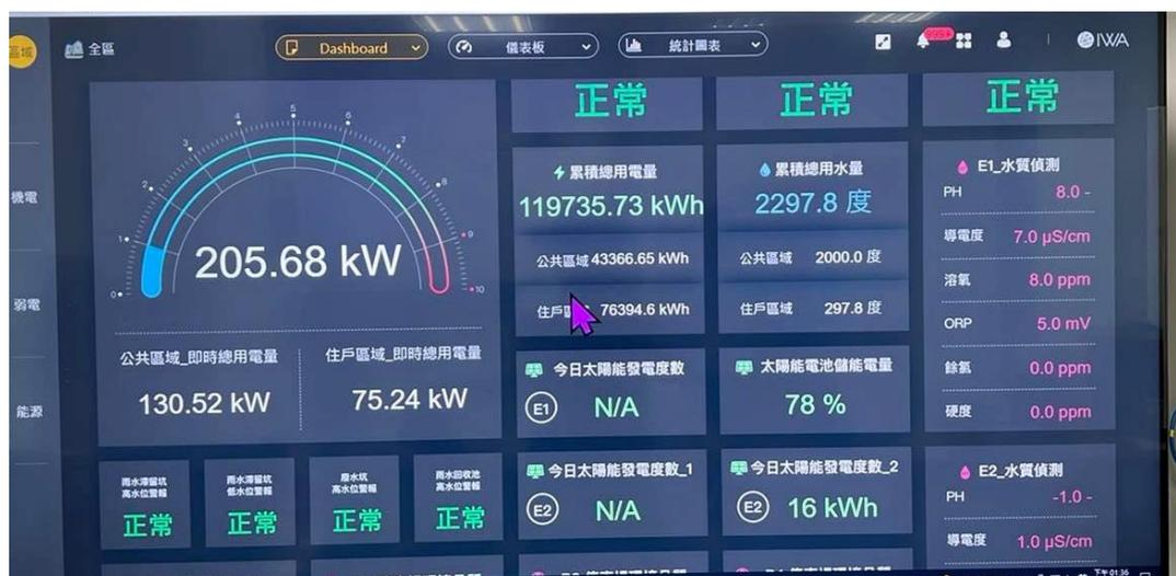
圖 3-9 智慧監控系統整合 ICT 智慧建築資訊平台之數據展示示意圖
