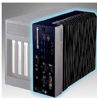
圖 1-3 兩水貯集滯洪設施智慧監控系統之決策主機
