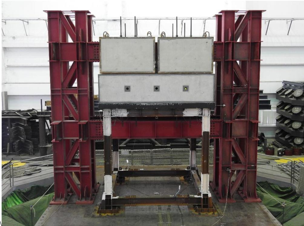
(a) 完成振動台實驗準備之鋼構實驗屋西面
