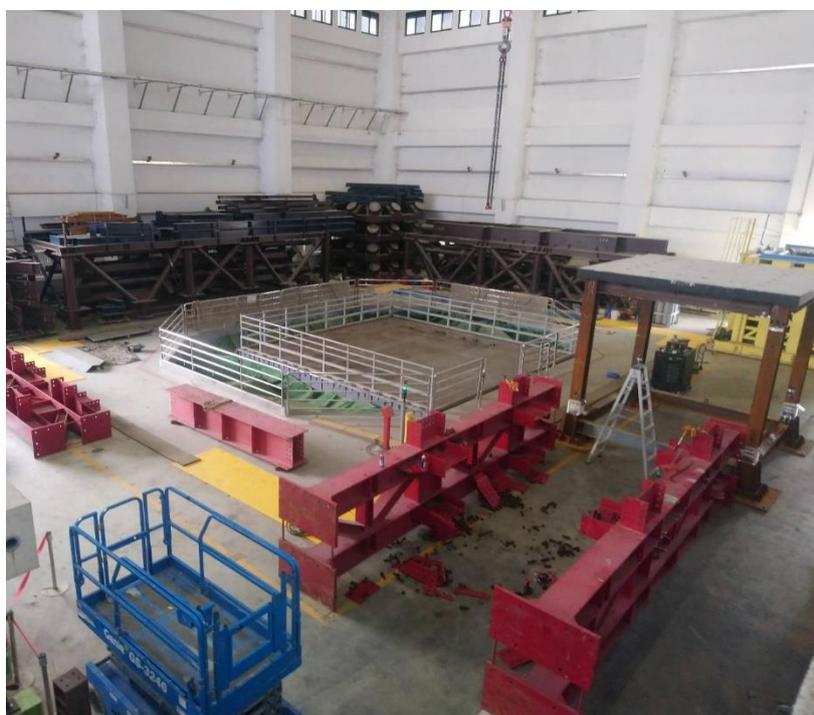
圖 5-43 長衝程高速度地震模擬振動台
