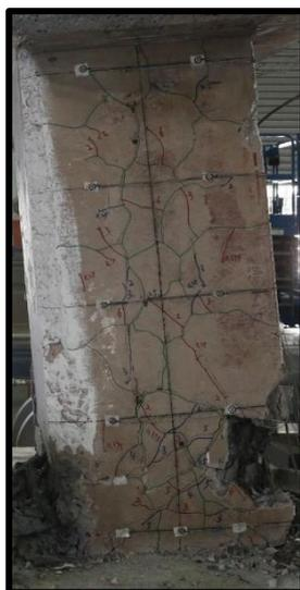
圖 3-42 F35 試體反覆載重實驗後外觀
