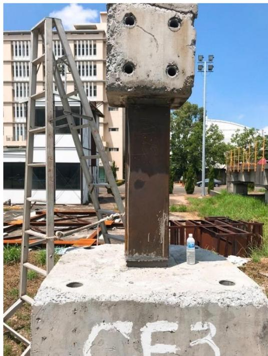
圖 4-13 拆模後之單柱試體
