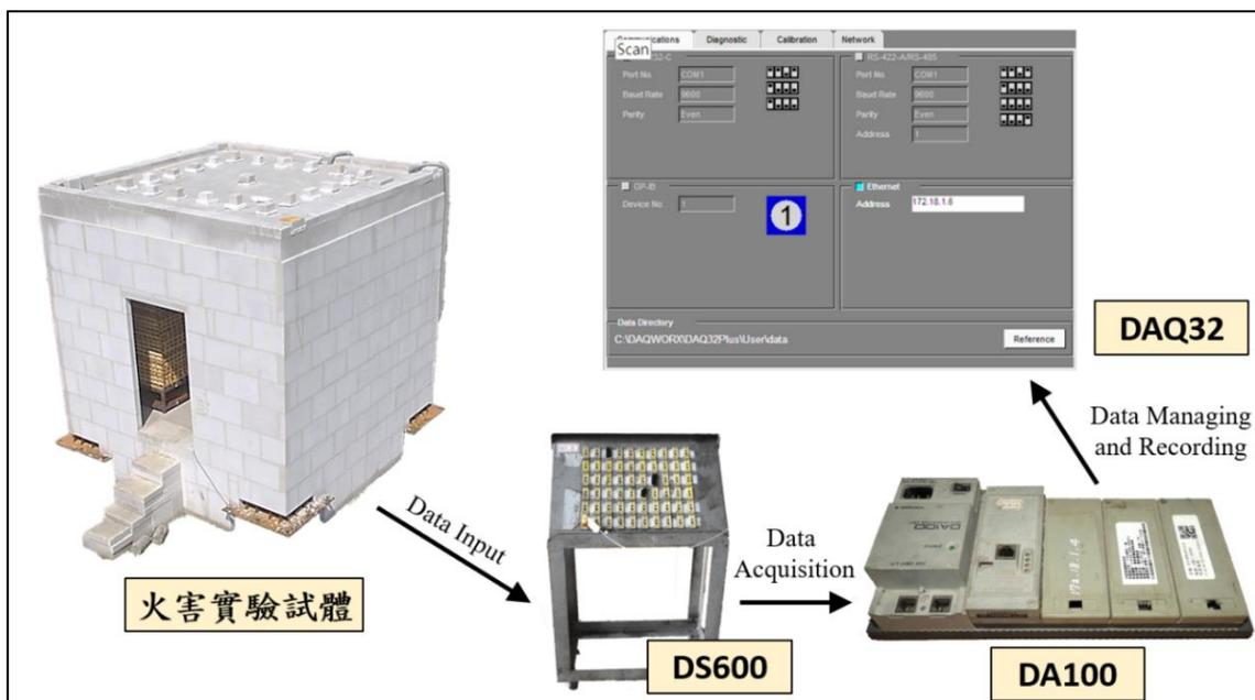
圖 5-27 資料擷取及儀器配置示意圖
