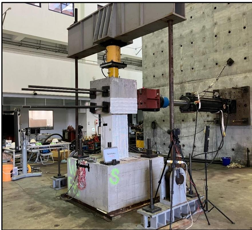
圖 3-33 反覆載重實驗實際架設圖
