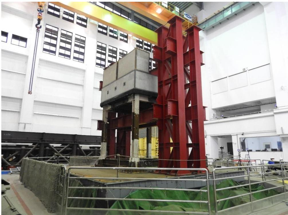
(b) 完成振動台實驗準備之鋼構實驗屋東北面
