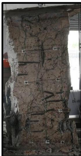
圖 3-45 F70 試體反覆載重實驗後外觀
