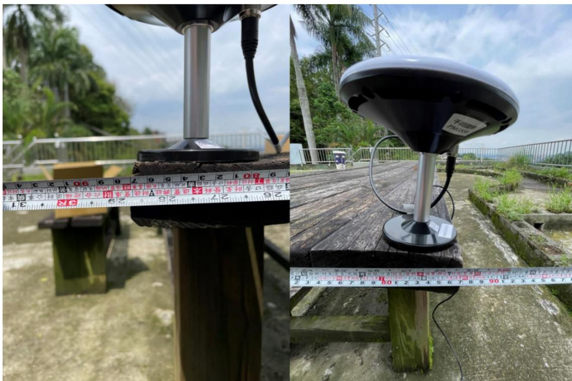
圖3-23 捲尺實際量測方法示意圖
