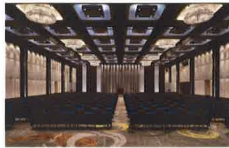
若事先申請，則能使用聽覺障礙者用集體助聽裝置的大型宴會廳（地板下方設有專用的配線。利用活動隔間牆能分成3個宴會場）
