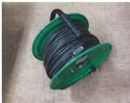
電磁感應線圈系統的天線電纜
