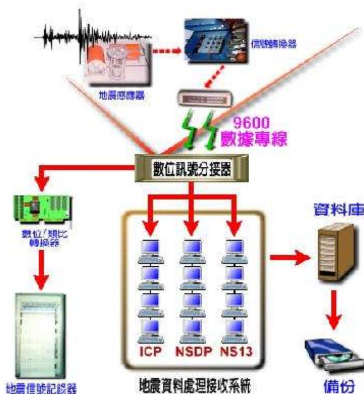
圖 14. 各地震站之數位信號全傳回臺北中心站[78]
