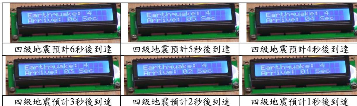
圖 57. 電子顯示器顯示預期到達地震震度及剩餘秒數
