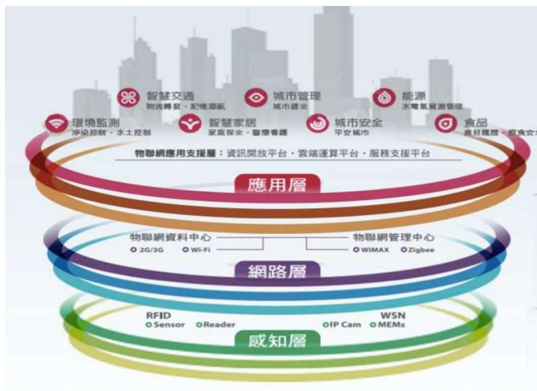
圖 22. 物聯網架構示意圖[23]
