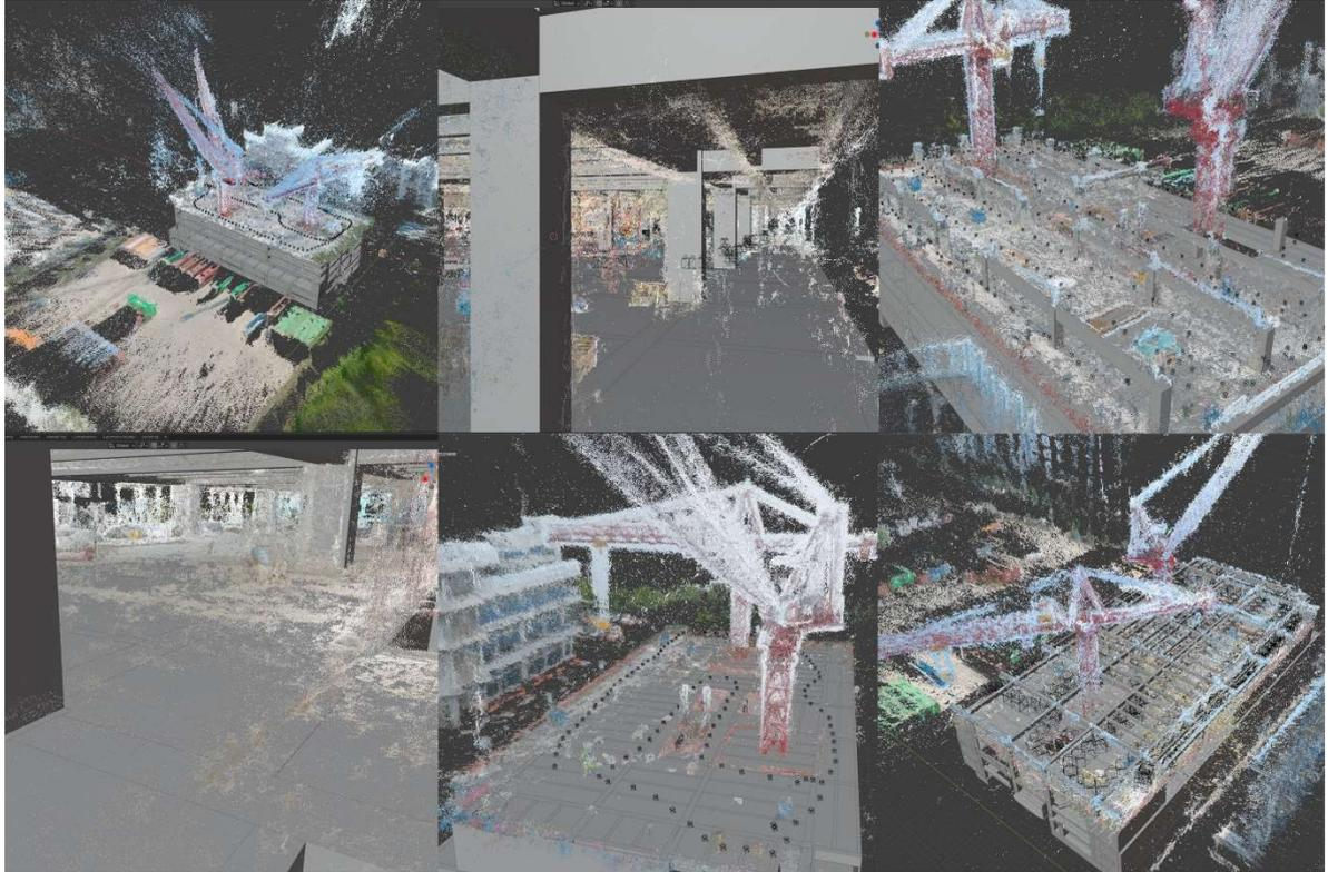
圖 3-6、將點雲模型貼合至 BIM 模型之成果
