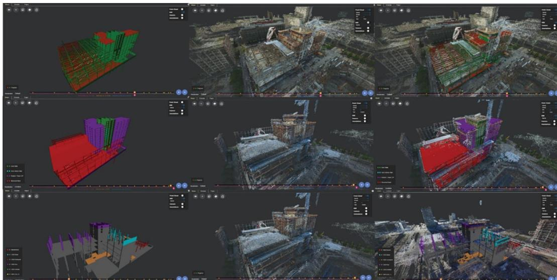
圖 2-5、第一列顯示透過 4D 點雲和 BIM 同步的進度；第二列顯示基於位置的 4D BIM 模型和進行的跟踪與點雲的集成；第三列顯示 4D BIM，其中分包商負責的任務用顏色編碼，以傳達誰在什麼位置從事什麼工作
