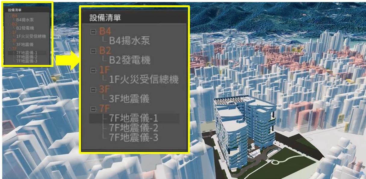
(a) BIM+ 3D GIS 設備資訊整合顯示畫面
