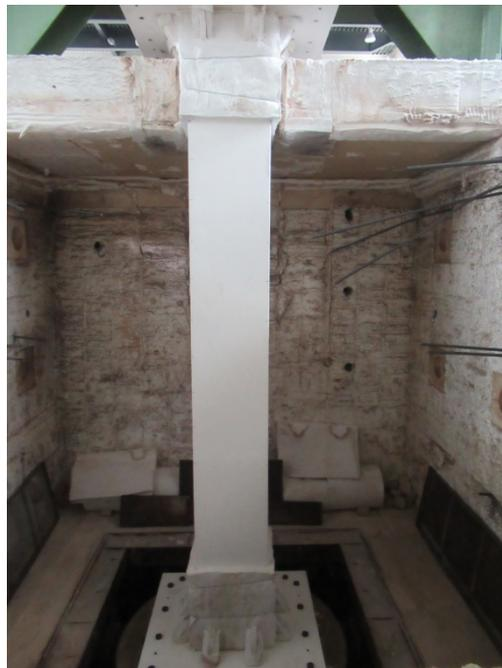
**圖 2.8 膨脹型防火漆的鋼柱(本研究整理)**
