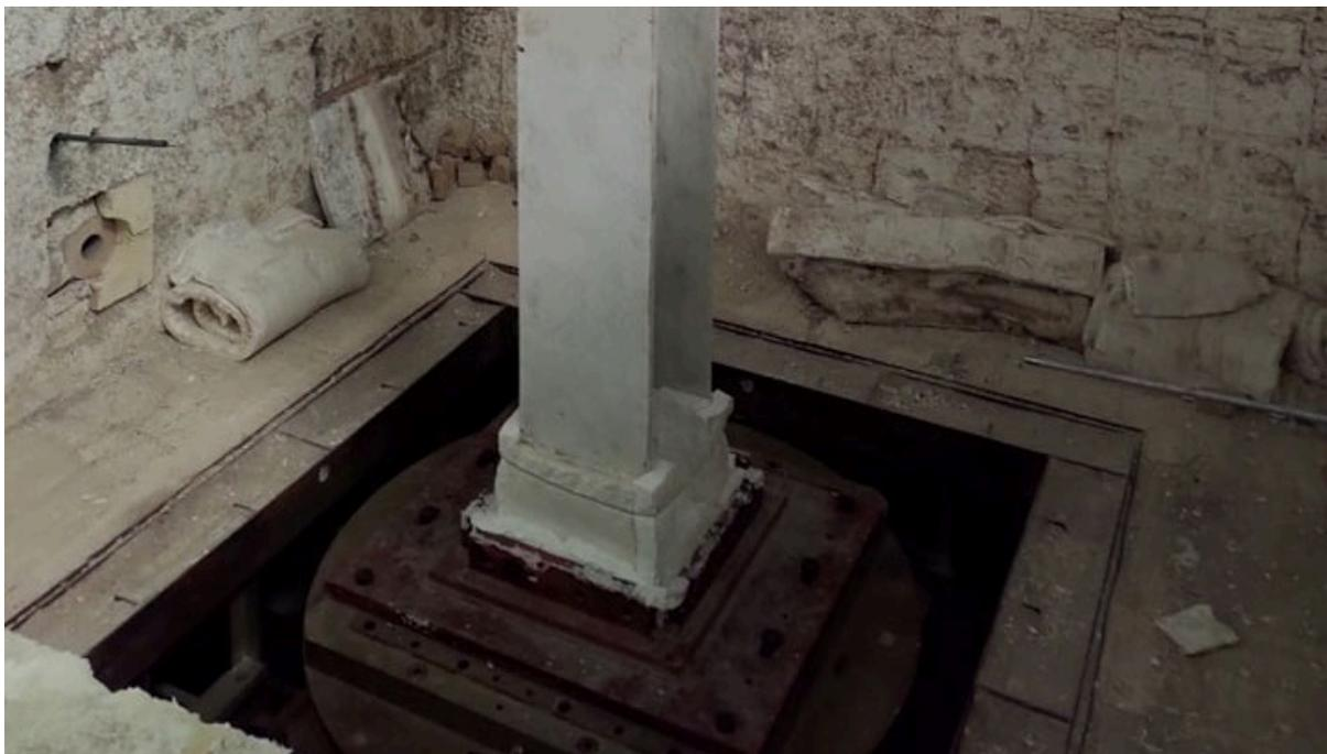
圖 4.3 現有梁柱耐火爐底
