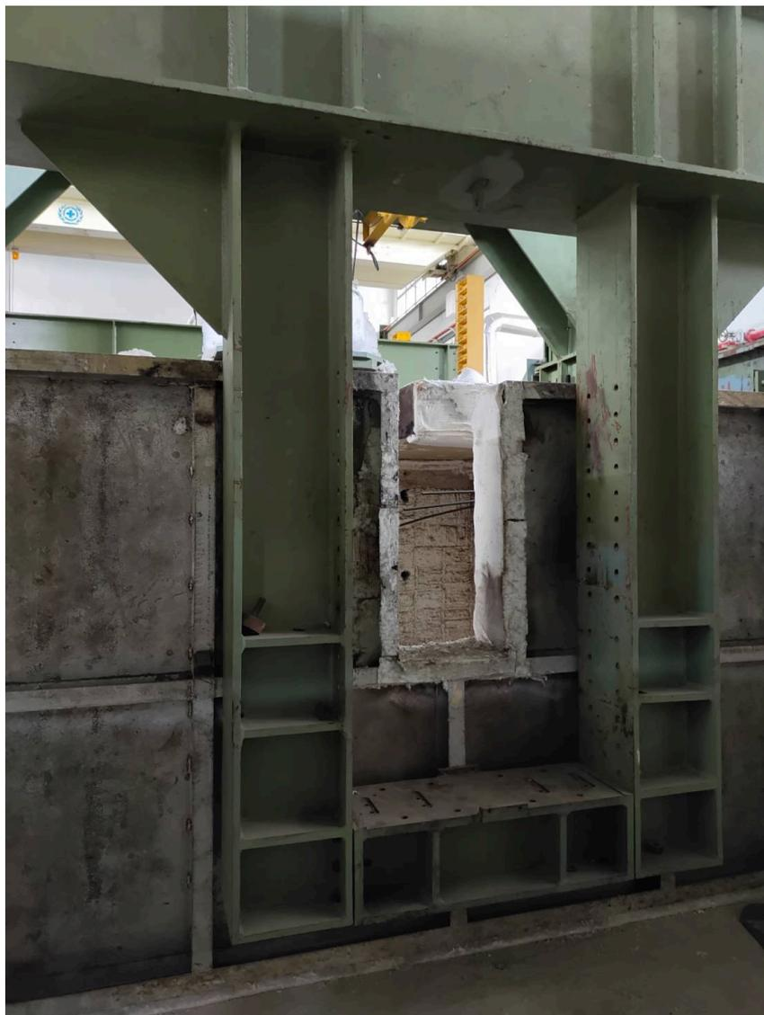
**圖 4.7 現有梁柱耐火爐支承座**
