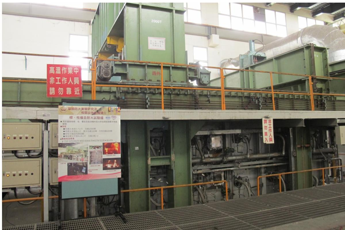
**圖3.1 柱和梁、樓板共用耐火爐**
