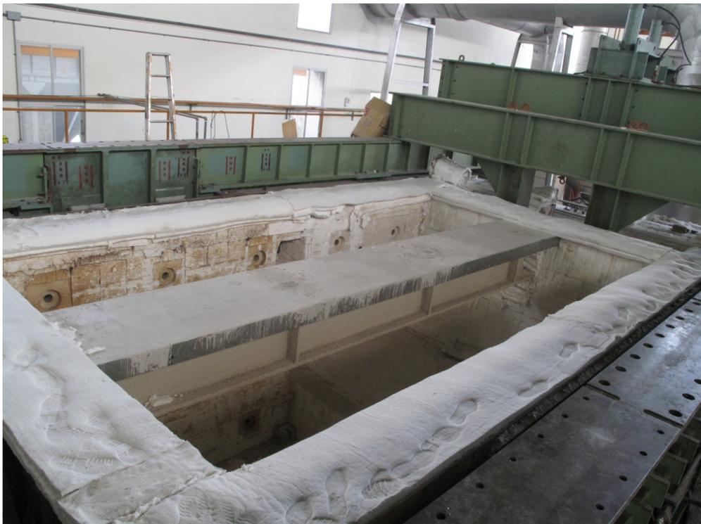
**圖 2.6 噴覆式防火被覆的鋼梁(本研究整理)**
