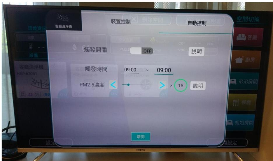
圖 4-15 空氣清淨機與新型態智慧家庭系統整合智慧控制
