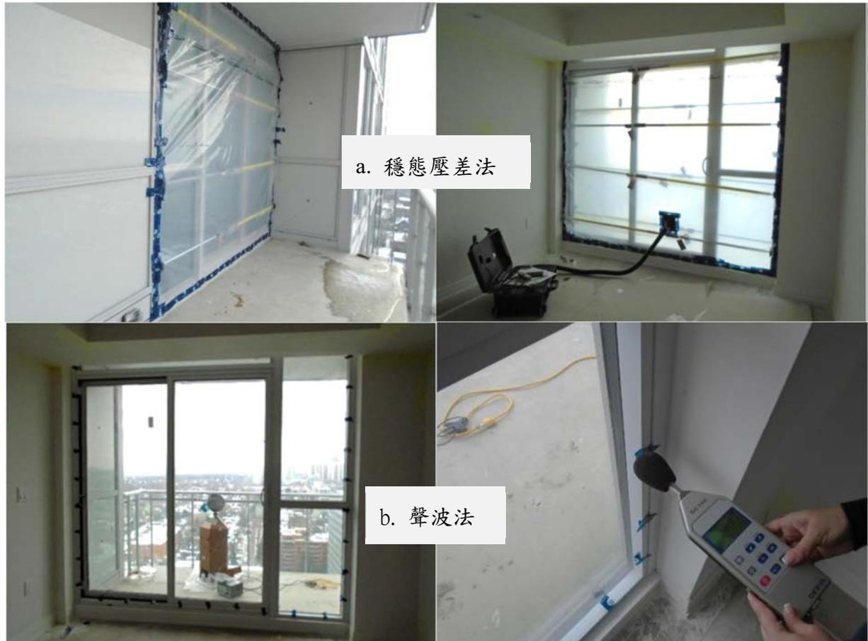
圖 2.21 穩態壓差法(a)與聲波法(b)測量窗氣密性之現場實測比對
