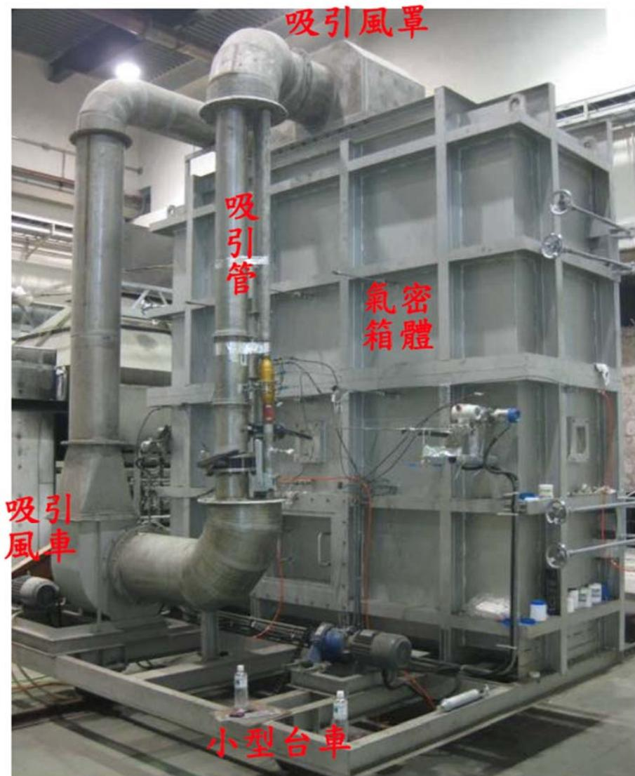
圖 2.6 測試艙構成
