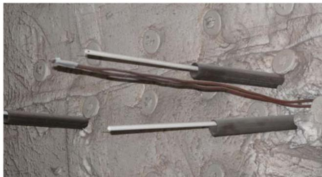
圖 2.8 壓差量測點及熱電偶
