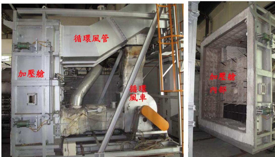
圖 2.5 加壓循環部構成
