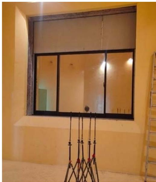
圖 1.4 聲學實驗室之窗戶隔音性能檢測
