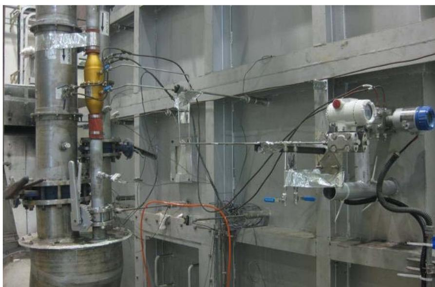
圖 2.11 煙洩漏量測裝置
