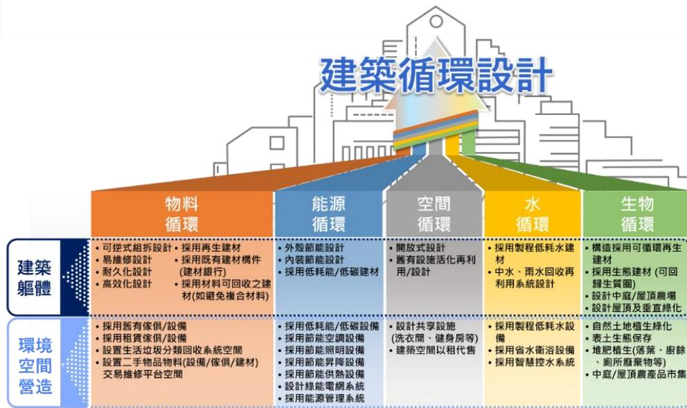
圖 6-1 建築循環設計架構
