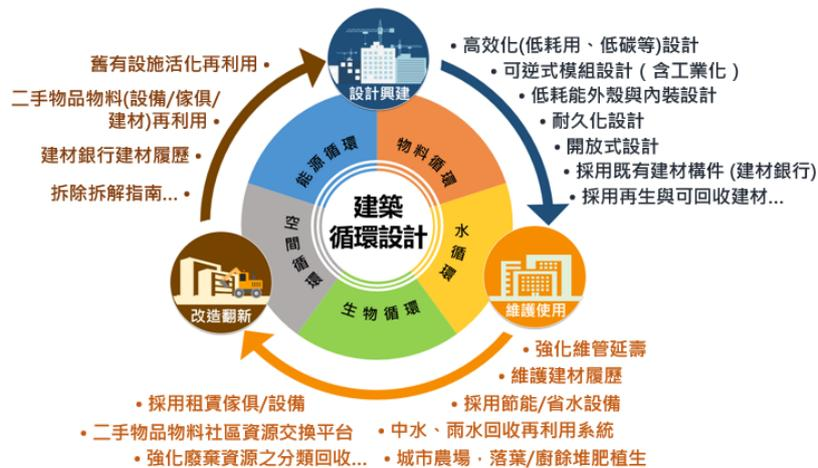
圖 6-2 建築生命週期循環設計架構
